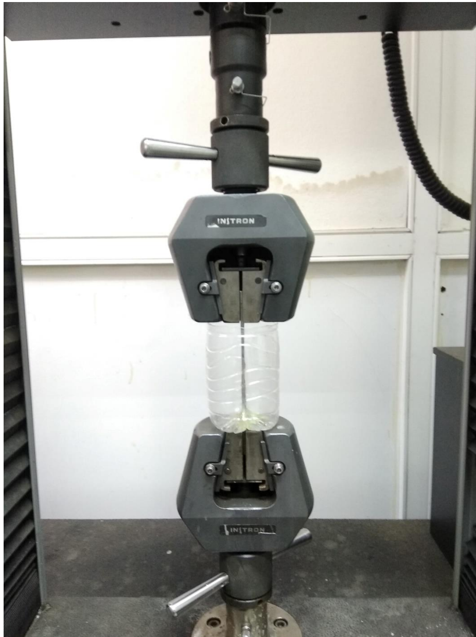
Εικόνα 40. Εγκυβωτισμένο δοκίμιο πάνω στη μηχανή εφελκυσμού. Ο πυθμένας του μπουκαλιού είναι κολλημένος στο τέλος του ωφέλιμου μήκους, κοντά στο καμπύλο τμήμα του δοκιμίου(radius). Τα grips του δοκιμίου βρίσκονται εκτός μπουκαλιού και είναι τοποθετημένα στις δαγκάνες της μηχανής.
