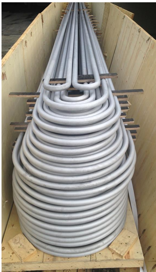
Εικόνα 17. Σωλήνες εναλλάκτη θερμότητας φτιαγμένοι από ωστενιτικό ανοξείδωτο χάλυβα S321/S321 H [24]
