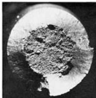
Εικόνα 32. Επιφάνεια θραύσης δοκιμίου εφελκυσμού χάλυβα 4340. Στο κέντρο της επιφάνειας θραύσης είναι η ινώδης επιφάνεια θραύσης (Fibrous zone) και περιμετρικά εκτείνεται το χείλος διάτμησης (Shear lip) [37]
