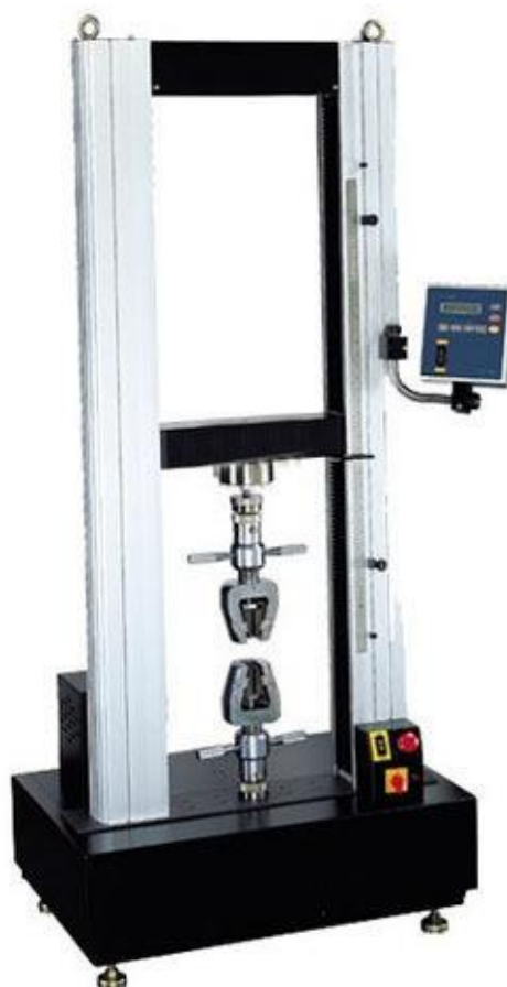
Εικόνα 20 . Μηχανή δοκιμής εφελκυσμού [31]
