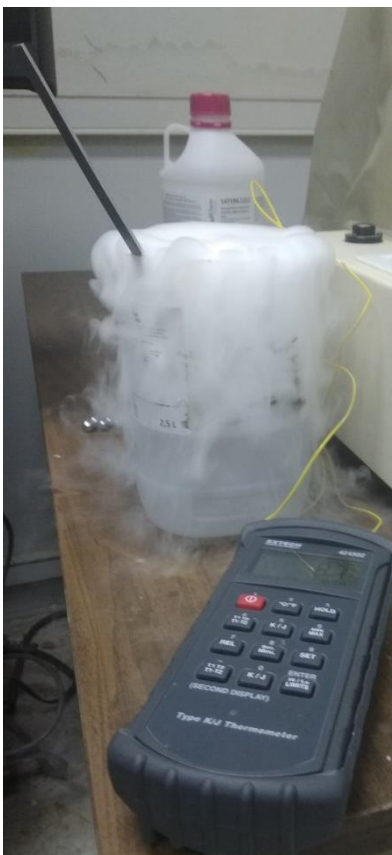
Εικόνα 42. Το δοχείο στο οποίο γινόταν η ανάμιξη αιθανόλης και υγρού αζώτου προτού μεταφερθεί στο μπουκάλι με το δοκίμιο.
