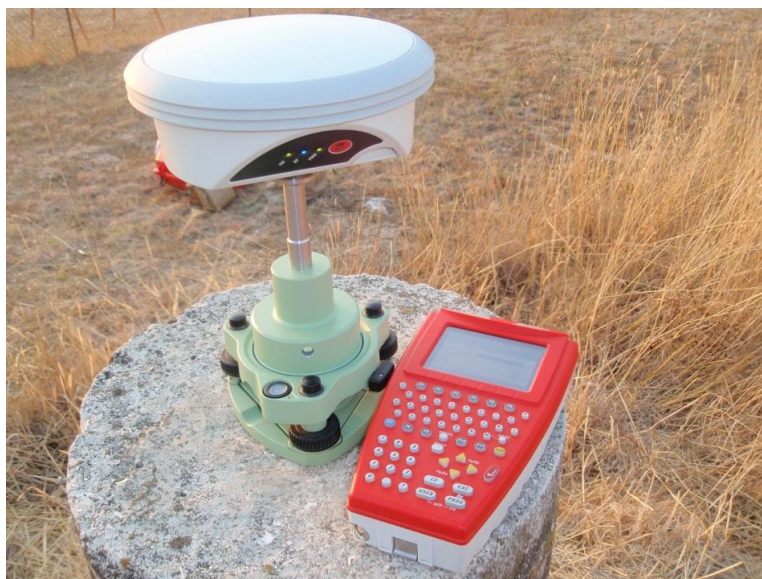
Εικόνα 4.16: Μέτρηση στατικού εντοπισμού στο τριγωνομετρικό σημείο “Άγια Παρασκευή”.
