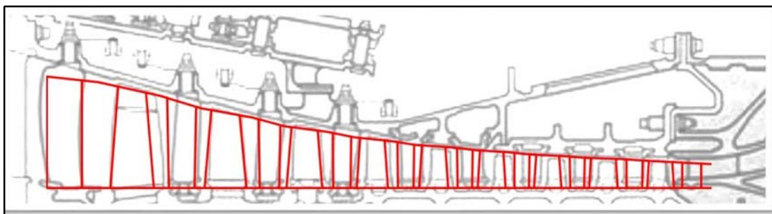
Σχήμα 5.11: Τελική γεωμετρία για τον συμπιεστή υψηλής πίεσης του CFM56/7B-27.
