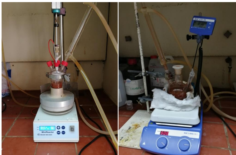
Εικόνα 20 Διάταξη αντιδραστήρων για την πραγματοποίηση πειραμάτων εκχύλισης, Αριστερά λειτουργία μηχανικής ανάδευσης, Δεξιά λειτουργία μαγνητικής
