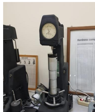
Εικόνα 2.15: Μηχάνημα στο οποίο διεξάγονται οι δοκιμές επιφανειακής σκληρότητας Rockwell
