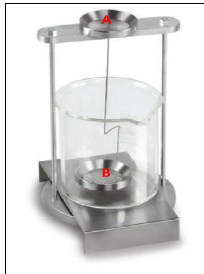
Εικόνα 2.13: Διάταξη για τον προσδιορισμό πυκνότητας σύμφωνα με την αρχή του Αρχιμήδη
