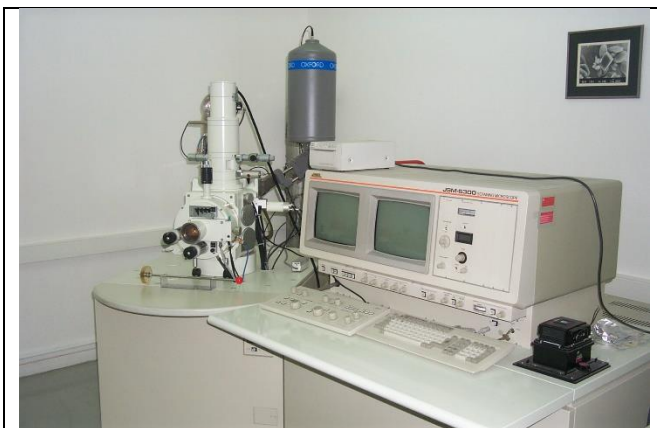
Εικόνα 2.8: Ηλεκτρονικό μικροσκόπιο σάρωσης JEOL6300
