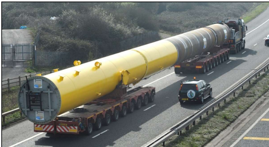
Σχήμα 3.2: Χαλύβδινος πάσσαλος κοίλης διατομής πλωτής εξέδρας (Bouckovalas et al. 2015).
