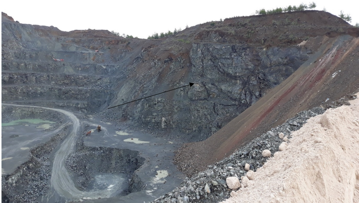
Φωτογραφία 2.3: Νότιο κομμάτι του λατομείου βρίσκεται η επαφή των ηφαιστιογενών πετρωμάτων με ιζηματογενή, ασβεστούχα πετρώματα
