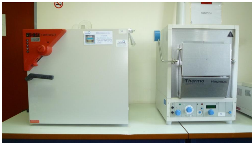
Εικόνα 3.5.1 : Φούρνοι για τον προσδιορισμό ολικών (αριστερά) και οργανικών (δεξιά) στερεών
