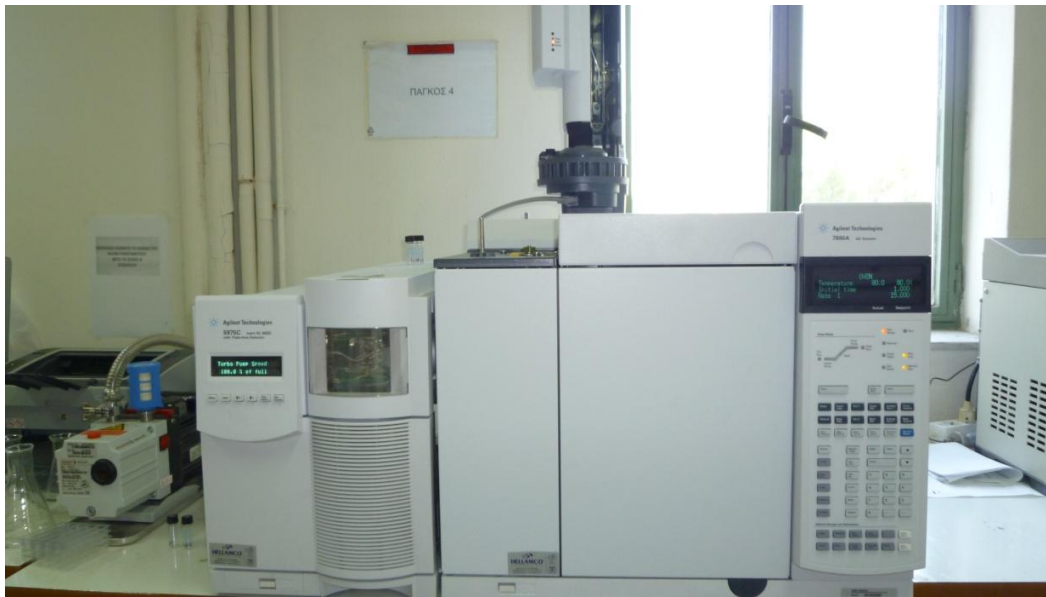
Εικόνα 3.9.1 : Αέριος χρωματογράφος τύπου Agilent 7890A συζευγμένος με φασματογράφο μάζας Agilent 5975C
