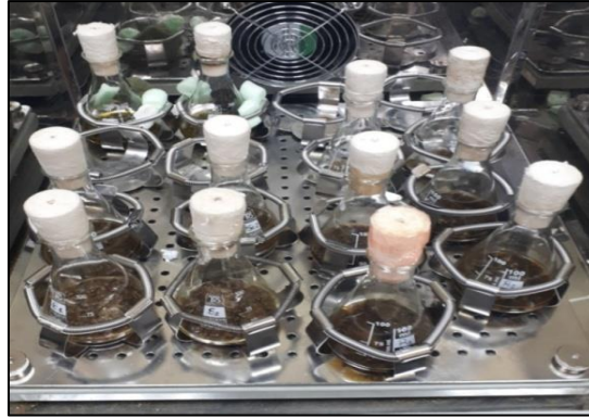
Εικόνα 6-3. Τα δείγματα στον αναδευτήρα (shaker) κατά την ενζυμικά υποβοηθούμενη εκχύλιση.
