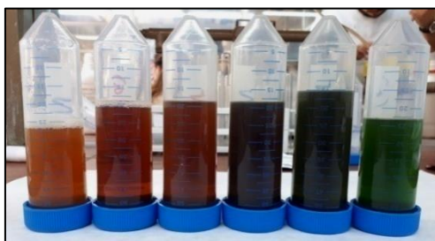
Εικόνα 6-2. Τα δείγματα μετά τη διήθηση. Από αριστερά προς τα δεξιά περιεκτικότητα διαλύτη: 100% \text{H}_2\text{O} , 20% EtOH, 40% EtOH, 60% EtOH, 80% EtOH, 100% EtOH
