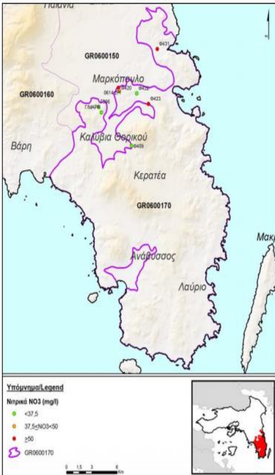
Εικόνα 39: Συγκέντρωση νιτρικών στο υπόγειο υδατικό διαμέρισμα της Λαυρεωτικής (Ι.Γ.Μ.Ε 2010)
