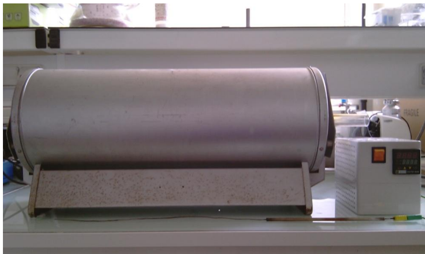
Εικόνα 11: Σύστημα απαέρωσης: Αποτελείται από το φούρνο, ένα ρυθμιστής θερμοκρασίας κι ένα θερμοζεύγος που τοποθετείται στο κέντρο του φούρνου όπου βρίσκονται τα δείγματα.
