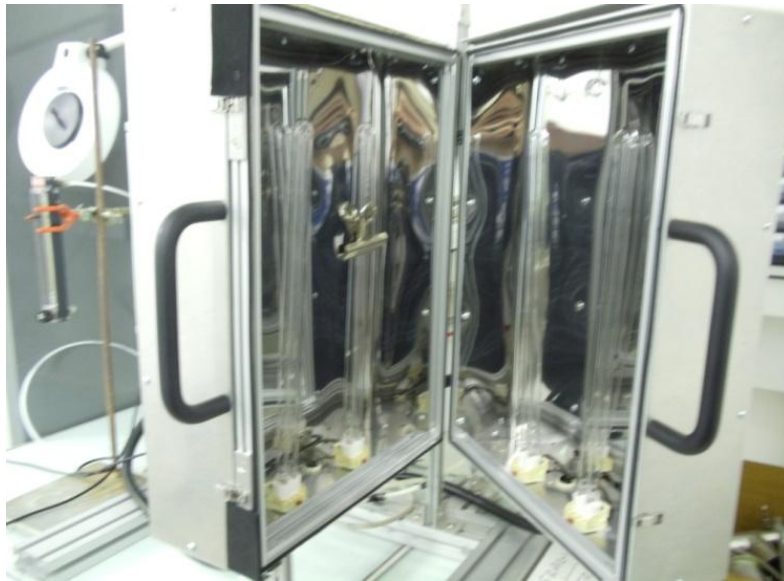
Εικόνα 9: Θάλαμος UV. Περιέχει 4 λάμπες υδραργύρου 64 W (NNI 60/35 XL) και το εύρος ακτινοβολίας κυμαίνεται από 185 έως 254 nm.
