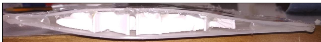
Εικόνα 48-Πλάγια όψη πτέρυγας με εσωτερική δομή Hexachiral
