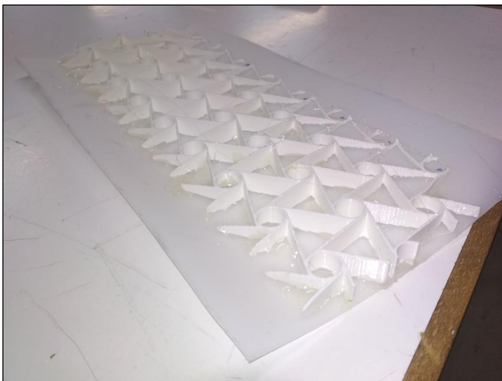
Εικόνα 46-Η Δομή Hexachiral κολλημένη στο κάτω φύλλο πλαστικού
