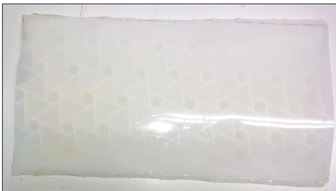
Εικόνα 47-Κάτοψη πτέρυγας με εσωτερική δομή Hexachiral
