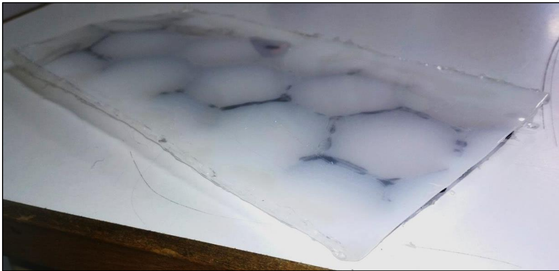
Εικόνα 44-Πτέρυγα με εσωτερική δομή Honeycomb
