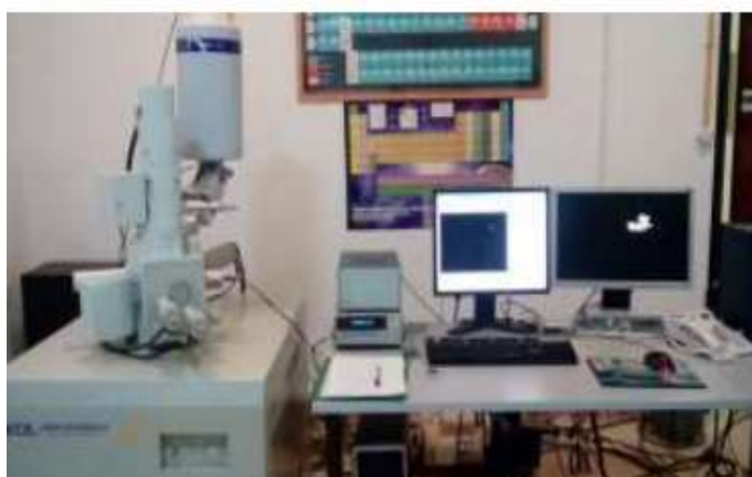
Εικόνα 2.9: Ηλεκτρονικό Μικροσκόπιο SEM (Jeol6380LV).
