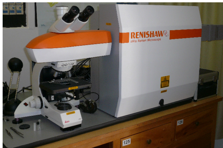
Εικόνα E5: Φασματόμετρο διασποράς Renishaw Invia- Reflex του εργαστηρίου Raman του Ινστιτούτου φυσικοχημείας του Ε.Κ.Ε.Φ.Ε. «Δημόκριτος».
