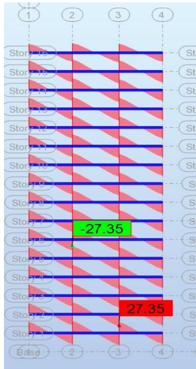
Εικόνα 3.20 Τέμνουσες δυνάμεων δοκών στον συνδυασμό G + Q + Wind y .
