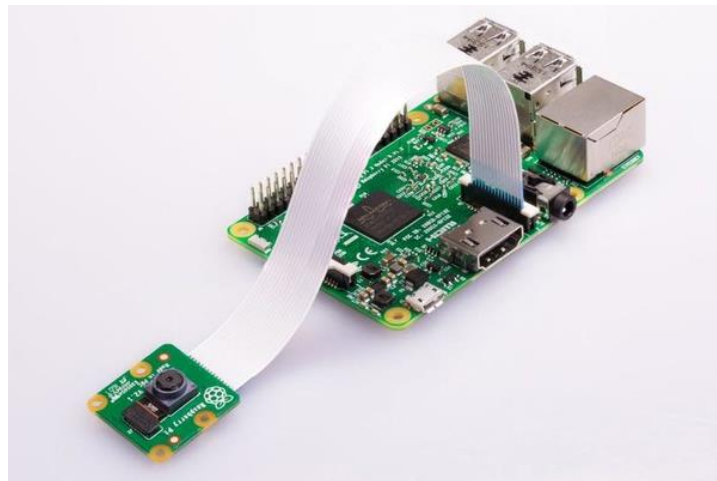
Εικόνα 37: Κάμερα συνδεδεμένη σε Raspberry Pi
