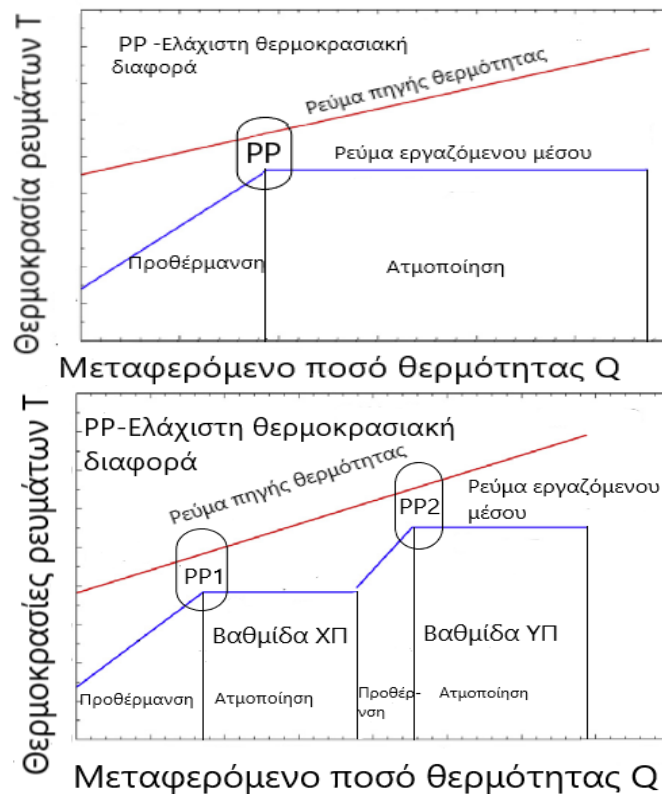
Εικόνα 18: Ποιοτικό διάγραμμα θερμοκρασιακών προφίλ εργαζόμενου μέσου και ρεύματος της πηγής θερμότητας συναρτήσει του ποσού θερμότητας που μεταφέρθηκε στον κύκλο (α) ενός μονοβάθμιου ORC συστήματος και (β) ενός διβάθμιου ORC συστήματος [44]
