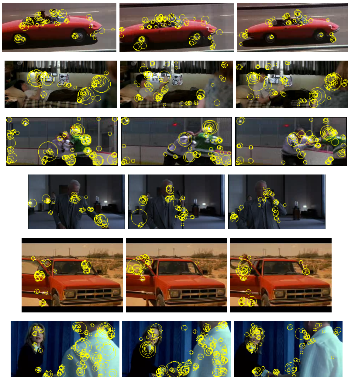
Σχήμα 2.2: Ανιχνεύσεις του Harris3D σε έξι δείγματα βίντεο της Βάσης Δεδομένων Hollywood2 Actions Dataset . Για κάθε δείγμα οι ανιχνεύσεις εμφανίζονται σε τρεις χρονικές στιγμές που απέχουν δώδεκα frames με τη μικρότερη χρονική στιγμή στην αριστερή στήλη και τη μεγαλύτερη στη δεξιά. Απεικονίζονται δείγματα από έξι διαφορετικές ανθρώπινες δράσεις της Hollywood2 . Από Επάνω προς τα Κάτω: DriveCar , SitUp , FightPerson , AnswerPhone , GetOutCar , HandShake
