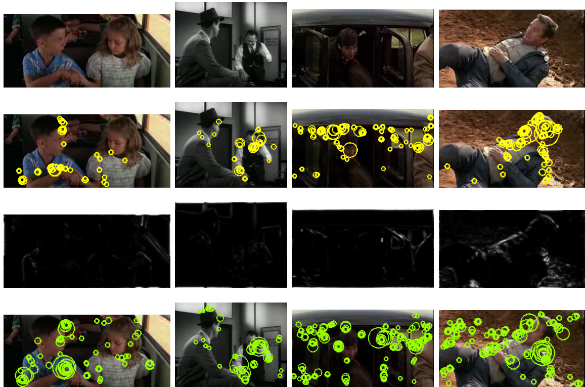
Σχήμα 4.5: Ανιχνεύσεις από τον Harris3D με βάση το καθιερωμένο και το εναλλακτικό σχήμα σε χαρακτηριστικά frames δειγμάτων βίντεο που ανήκουν στις δράσεις Handshake , AnswerPhone , GetOutCar και SitUp (από Αριστερά προς τα Δεξιά). Από Επάνω προς τα Κάτω: αρχικά έγχρωμα frames, ανιχνευθέντα σημεία με είσοδο τα αρχικά frames, αντίστοιχες εικόνες EDCA Κυρίαρχης Ενέργειας, ανιχνευθέντα σημεία με είσοδο τις εικόνες EDCA Κυρίαρχης Ενέργειας εικονιζόμενα επί των αρχικών frames.
