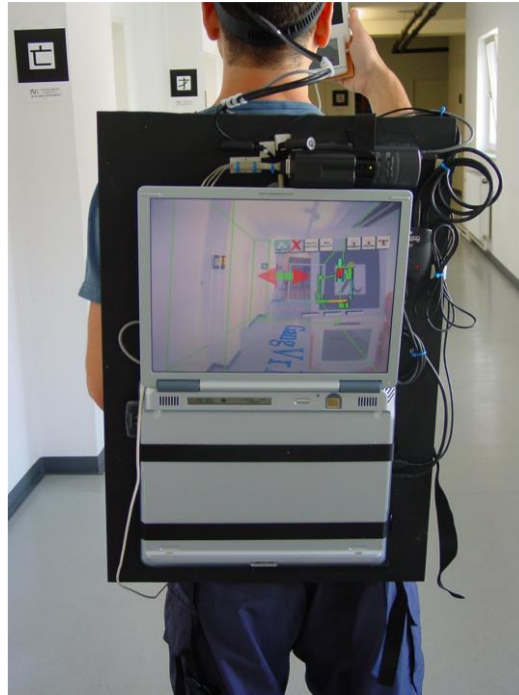
Σχήμα 5.5: Σύστημα πλοήγησης βασισμένο στην αναγνώριση κωδικών εικόνων
