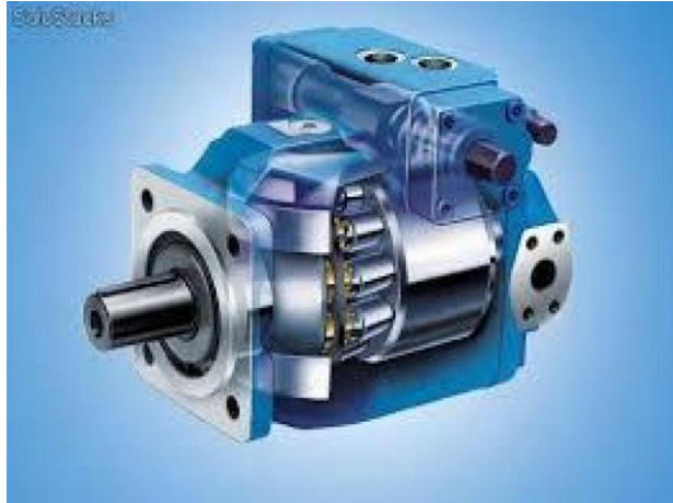
Σχέδιο 49. Αντλία μεταβλητής παροχής REXROTH σειράς A4VSO. Η συγκεκριμένη αντλία χρησιμοποιείται κυρίως σε μεγάλες εφαρμογές, όπως είναι οι υδραυλικοί μετωπικοί εκσκαφείς ή οι εκσκαφείς συρόμενου κάδου. Αυτό συμβαίνει, διότι οι αντλίες αυτές φθάνουν μέχρι 1000 κυβικά εκατοστά σε μέγεθος. Είναι αντλία ανοικτού κυκλώματος. Η πίεση της φθάνει τα 400 bar. (Rexroth 2020)
