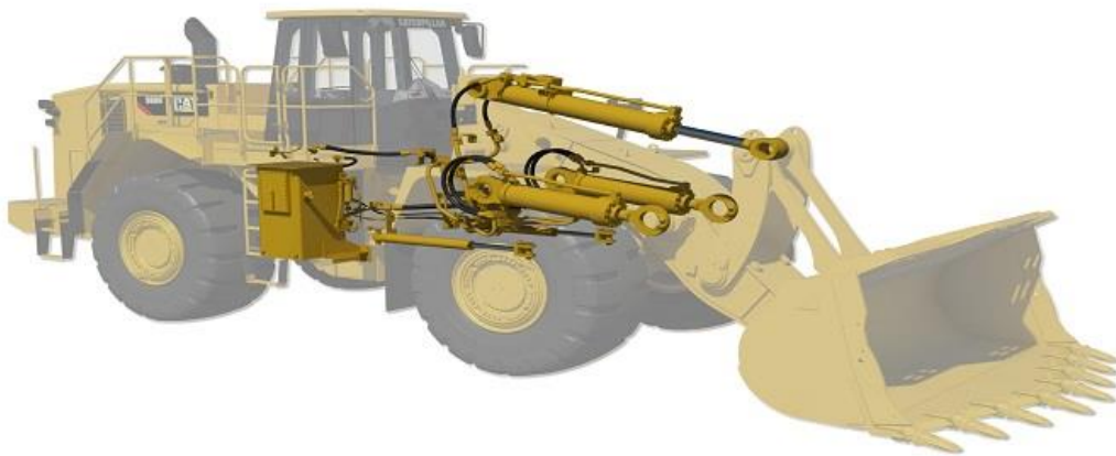
Σχήμα 68. Υδραυλικοί κύλινδροι σε έναν ελαστικοφόρο φορτωτή. Στην φωτογραφία φαίνεται και η δεξαμενή λαδιού. (Caterpillar 2020)
