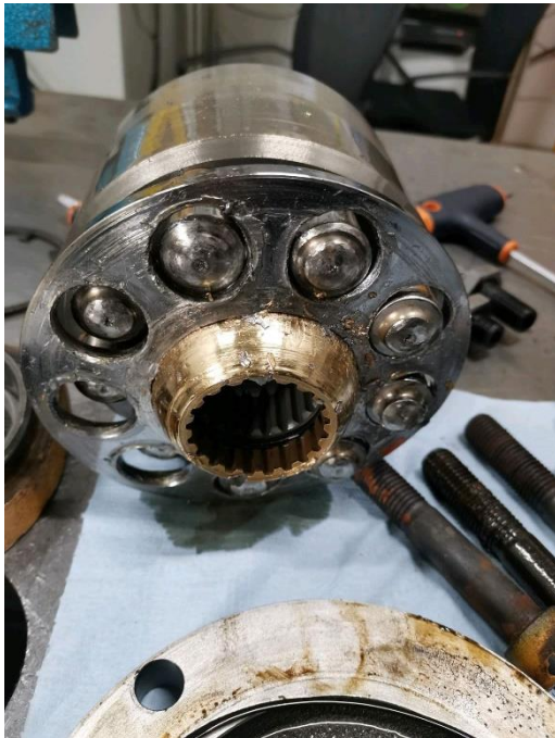
Σχήμα 104. Επάνω αντλία KAWASAKI K3V, κάτω αριστερά περιστρεφόμενο τμήμα αντλίας REXROTH σειράς A4VG, κάτω δεξιά περιστρεφόμενο τμήμα πτερυγιοφόρου αντλίας DENISON PARKER. Όλα εντελώς κατεστραμένα μετά από λειτουργία έως την βλάβη. (Hydraulics and Pneumatics 2020)
