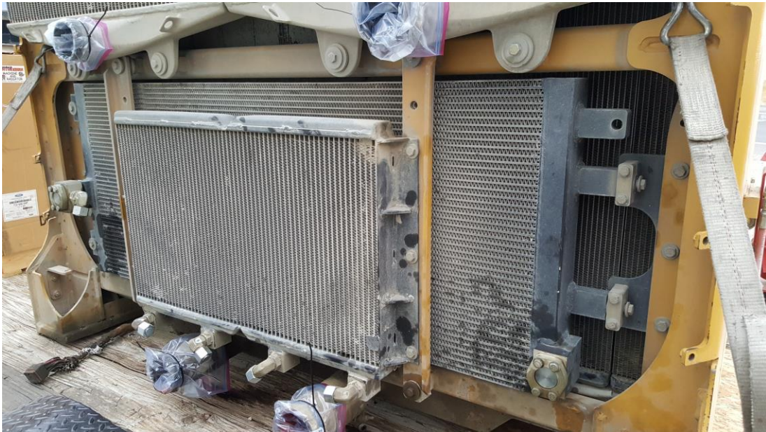
Σχήμα 16. Ψύκτης αέρος όπου θερμό υδραυλικό ρευστό ψύχεται με αέρα, σε CATERPILLAR 854K. (Motor Mission 2020)
