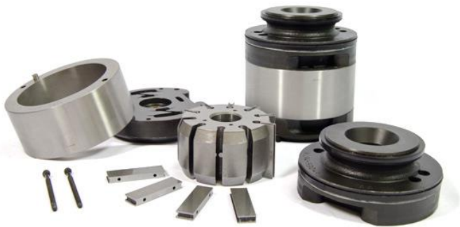
Σχήμα 37. Διφορετικοί τύποι μηχανισμών των περυγιοφόρων αντλιών. Επάνω VICKERS, κάτω PARKER DENISON. (Eaton, Parker 2020)
