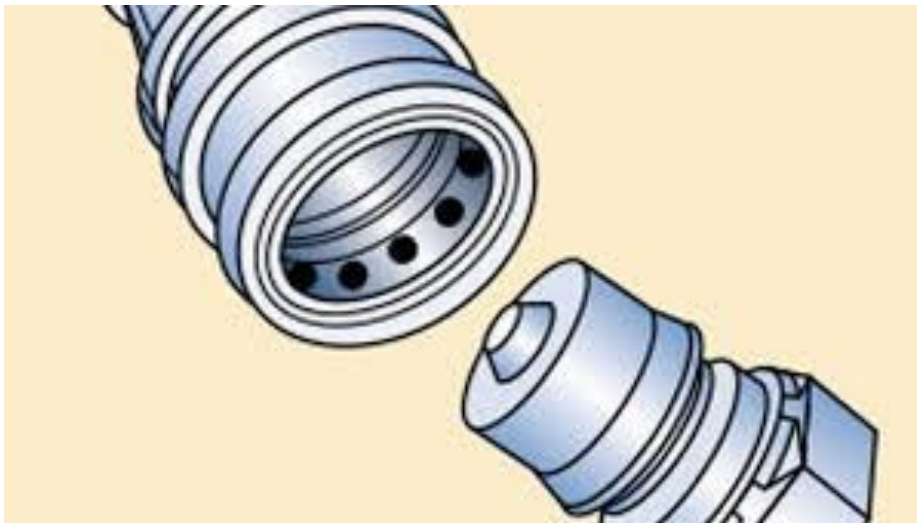
Σχήμα 3. Μηδενικές μηχανουργικές ανοχές σε έναν ταχυσύνδεσμο ( Hydraulics and Pneumatics 2020)
