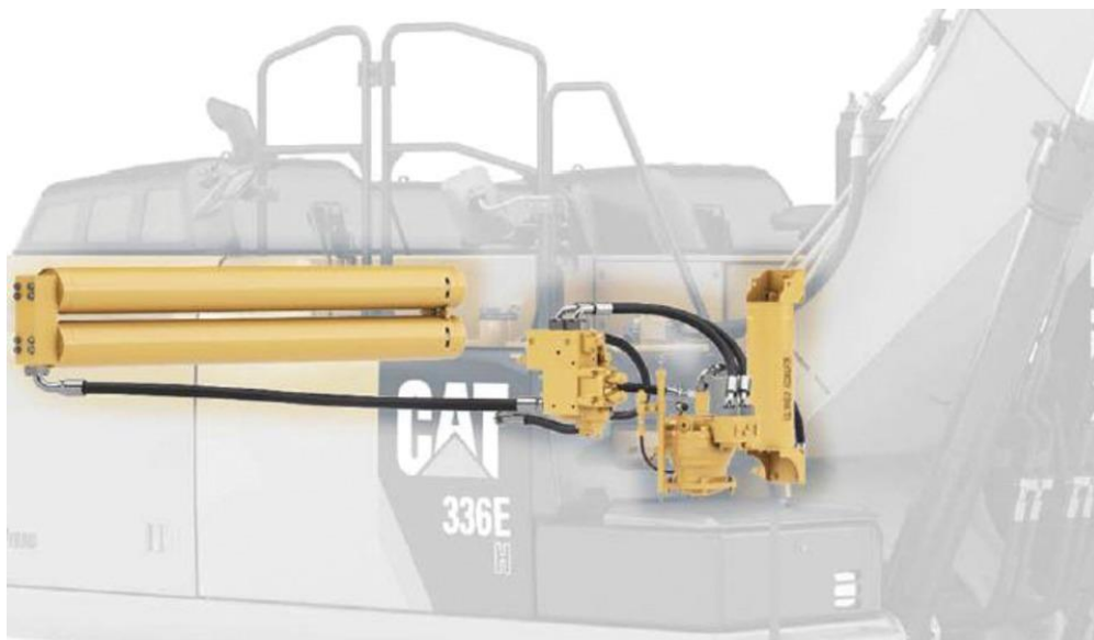
Σχήμα 20. Στην συγκεκριμένη εικόνα φαίνονται δύο συσσωρευτές, ένα βαλβιδοφόρο και ένας κινητήρας περιστροφής, καθώς και εύκαμπτοι αγωγοί που συνδέουν όλα τα προηγούμενα, σε έναν εκσκαφέα CATERPILLAR 336E H. Οι συσσωρευτές παρέχουν λάδι υπό πίεση στο φρένο του κινητήρα περιστροφής. (Caterpillar 2020)
