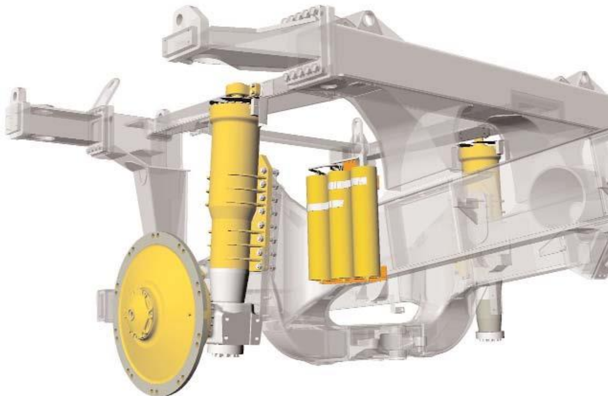
Σχήμα 69. Σύνολο υδραυλικών κυλίνδρων και συσσωρευτών σε φορτηγό μεταλλείων. (Caterpillar 2020)
