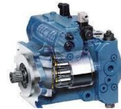
Σχέδιο 50. Αντλία μεταβλητής παροχής REXROTH σειράς A4VG, μία από τις σημαντικότερες, συνηθέστερες και ισχυρότερες αντλίες. Η πίεση της φθάνει και τα 450 bar. Είναι αντλία κλειστού κυκλώματος. (Rexroth 2020)
