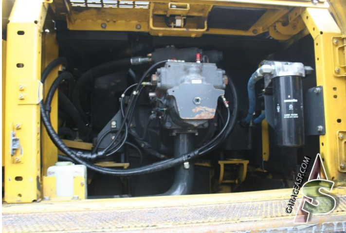
Σχέδιο 45. Διπλή αντλία μεταβλητής παροχής για ερπυστριοφόρο εκσκαφέα KOMATSU PC 350. (Garage ASP 2020)
