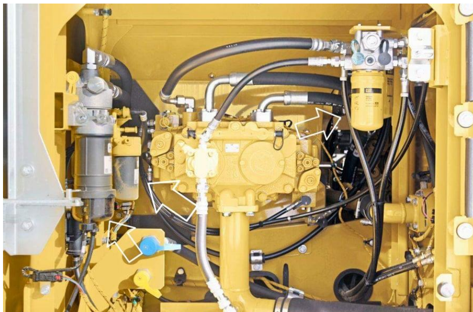
Σχήμα 15. Κύρια αντλία CAT SBS 120 σε εκσκαφέα CATERPILLAR 320F L. Στην φωτογραφία φαίνονται μερικά από τα φίλτρα του δικτύου. (Caterpillar 2020)
