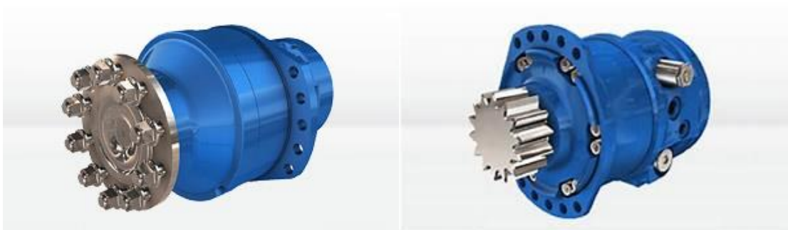
Σχήμα 65. POCLAIN κινητήρες. Αριστερά κινητήρας πορείας ακτινικών εμβόλων σειράς MS και δεξιά κινητήρας περιστροφής ακτινικών εμβόλων σειράς MZ. Εφαρμόζονται σε POCLAIN, CATERPILLAR και άλλους εκσκαφείς. (Poclain 2020)
