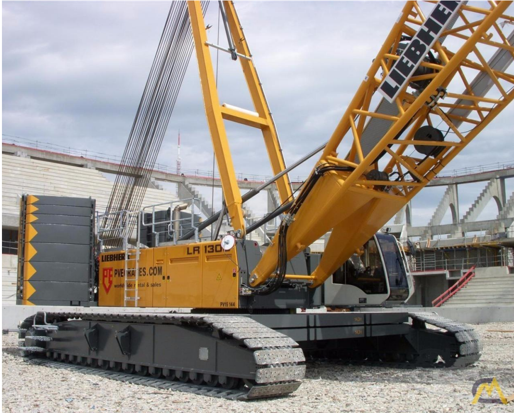
Σχήμα 62. Σε ειδικές περιπτώσεις ο παραπάνω κινητήρας εφαρμόζεται και σε γερανούς ξηράς πολύ μεγάλου μεγέθους, όπου σε συνδυασμό με κάποιο μειωτήρα χρησιμοποιείται για την άρση μεγάλων βαρών. Στην φωτογραφία: γερανός LIEBHERR LR 1300, δυναμικότητας 330 τόννων. (Liebherr 2020)
