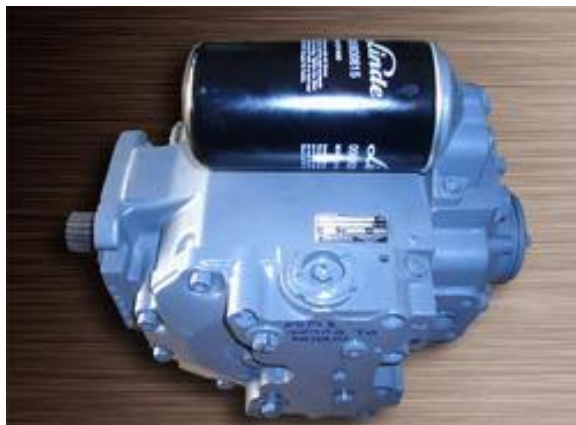
Σχήμα 13. Αντλίες Linde, σειρά BPV με εφαρμοσμένο φίλτρο για την χαμηλή πίεση της βοηθητικής αντλίας. (Linde 2020)
