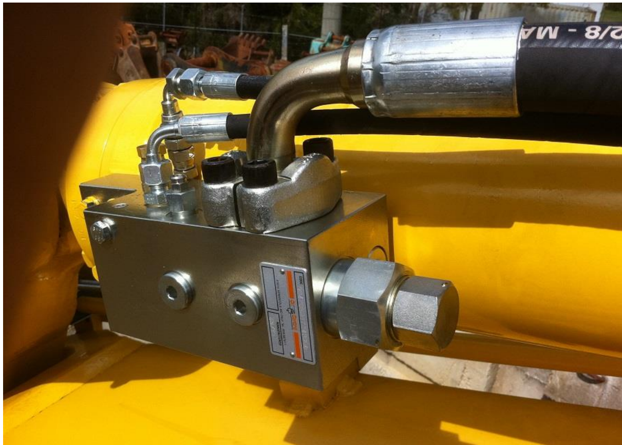
Σχήμα 78. Βαλβίδα αντισταθμίσεως σε υδραυλικό κύλινδρο. (Hydraulics and Pneumatics 2020)
