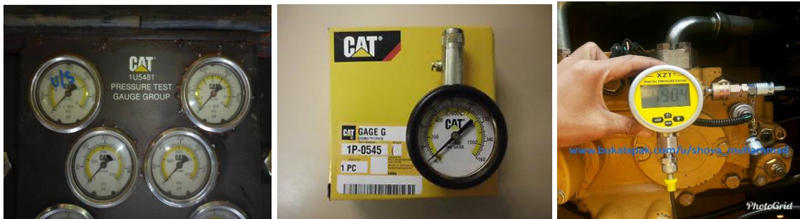
Σχήμα 22. Αριστερά μανόμετρα ελάσματος CATERPILLAR. Δεξιά XZT ψηφιακό μανόμετρο τελευταίας γενιάς, ευκολότερο στη χρήση. (Caterpillar 2020)
