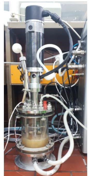
Εικόνα 21: α) Βιοαντιδραστήρας 2L σε λειτουργία με θρεπτικό υλικό στο εσωτερικό του, κατόπιν αποστείρωσης β) Καλλιέργεια C. coli σε βιοαντιδραστήρα 2L, 24 h λειτουργίας
