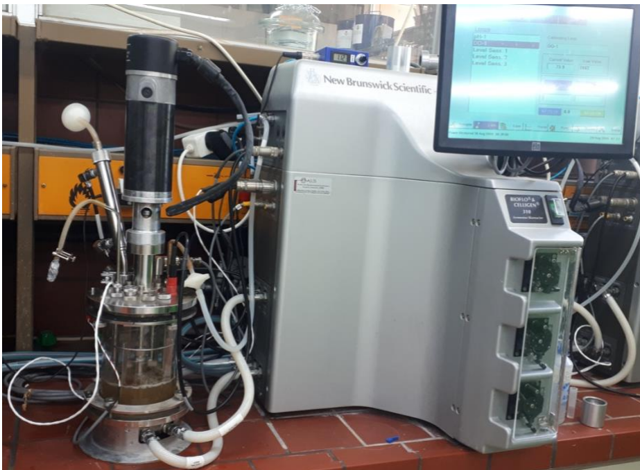
Εικόνα 21: α) Βιοαντιδραστήρας 2L σε λειτουργία με θρεπτικό υλικό στο εσωτερικό του, κατόπιν αποστείρωσης β) Καλλιέργεια C. coli σε βιοαντιδραστήρα 2L, 24 h λειτουργίας
