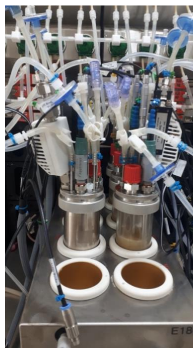
Εικόνα 22: α) Βιοαντιδραστήρες 200 mL πριν τεθούν σε λειτουργία και β) αφού τεθούν σε λειτουργία και μετά τον εμβολιασμό τους από κουνιστό εμβόλιο
