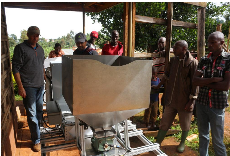
Εικόνα 23.: Ρομποτικός μηχανισμός κατηγοριοποίησης καφέ (Bext360,2018)
