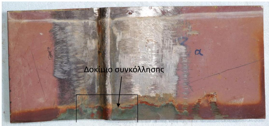
Εικόνα 48: Θέση δοκιμίου στη συγκόλληση
