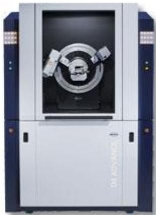
Εικόνα 15 : Όργανο XRD που χρησιμοποιήθηκε για τις μετρήσεις (14)
