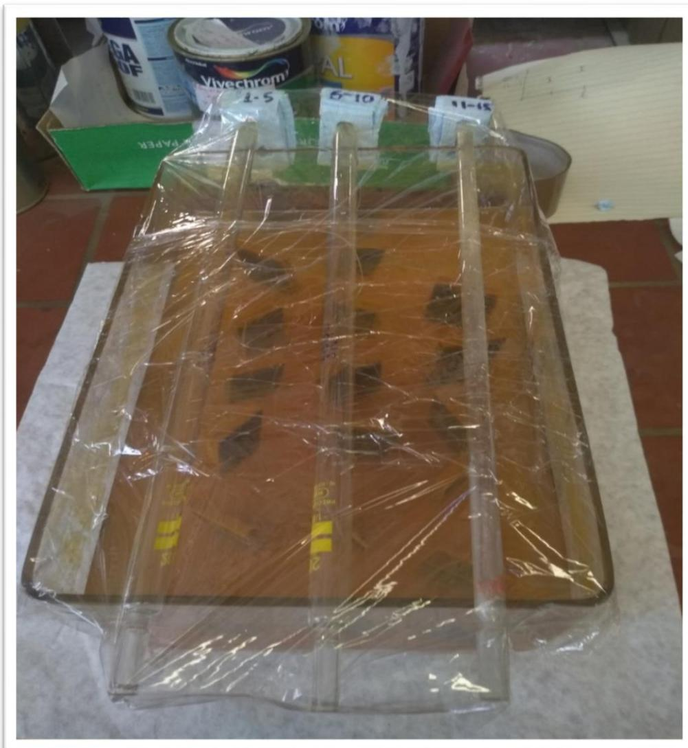
*Εικόνα 14 : Διάταξη εμβάπτισης δοκιμίων*
