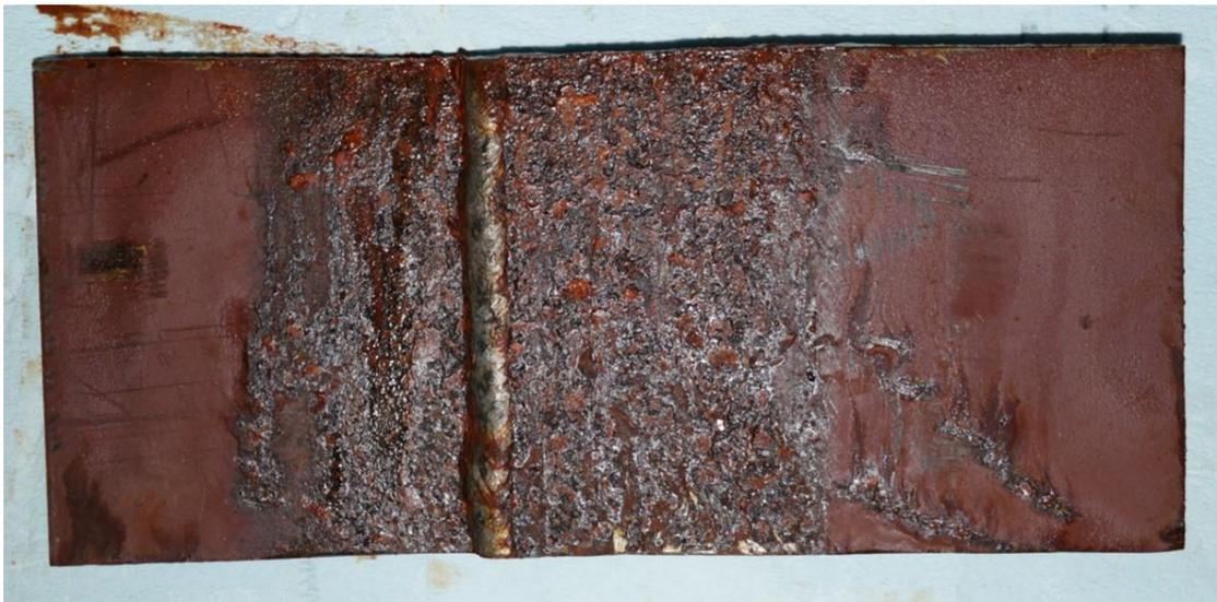
*Εικόνα 50 : Έλασμα που έχει υποβληθεί σε δοκιμή αλατονέφωσης.*
