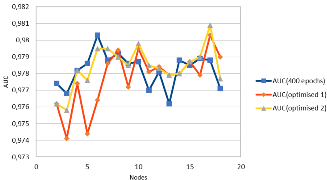
Εικόνα 0.13 Σχεδιαγραμματική απεικόνιση της μεταβολής της απόδοσης (εμβαδόν κάτω από την καμπύλη (AUC/ Area Under Curve) του λειτουργικού χαρακτηριστικού δείκτη (ROC/ Receiver Operating Characteristics ) του νευρωνικού δικτύου για διαφορετικό αριθμό κόμβων και εποχών
