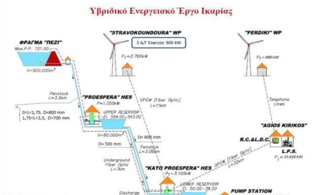
Σχήμα 2.10: Εσωτερική διαμόρφωση του ΥΒΕ και λοιπές μονάδες παραγωγής συστήματος της Ικαρίας 2013 (Πηγή: ΔΕΗ Ανανεώσιμες)
