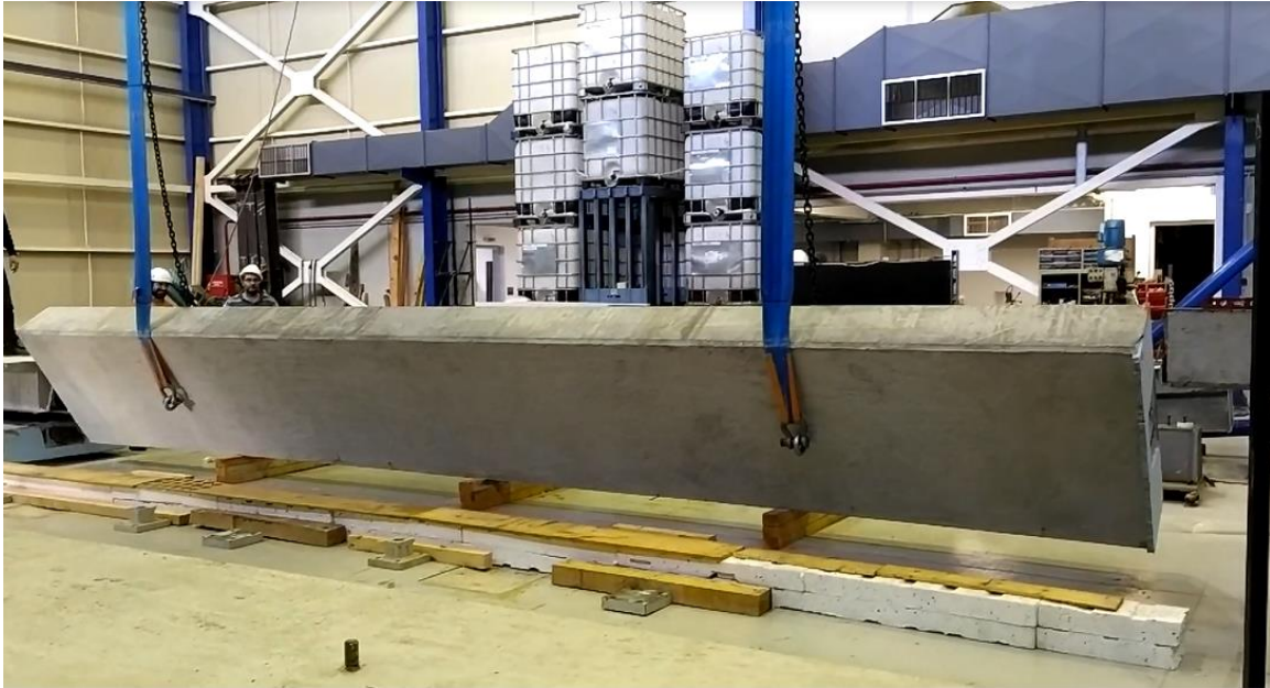
Σχήμα 2.12: Δοκίμιο H2 κατά τη δεύτερη φάση της ανατροπής.
