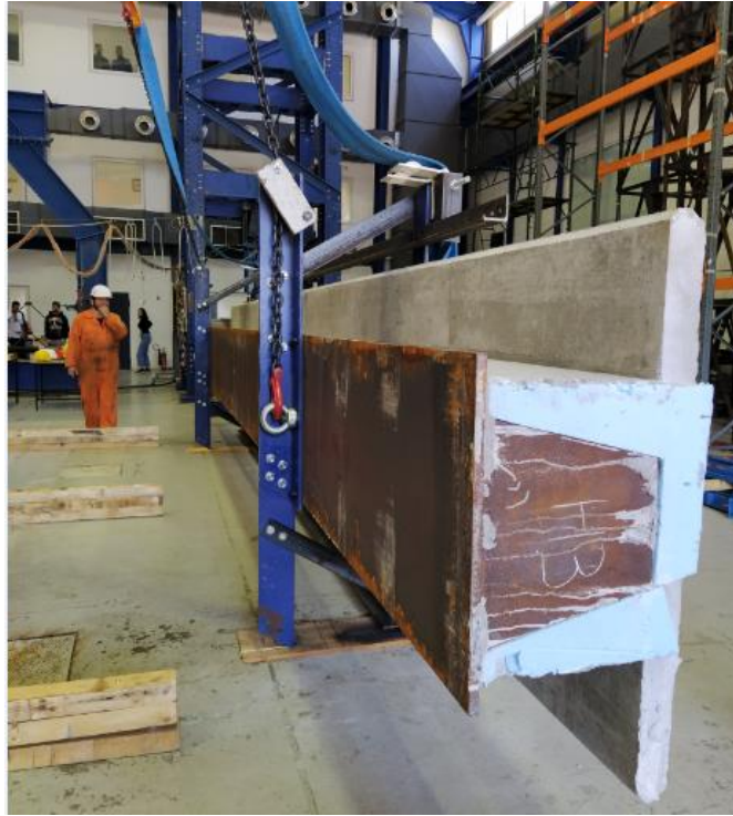
Σχήμα 2.10: Δοκίμιο Η3 κατά το τέλος της πρώτης φάσης της ανατροπής.
