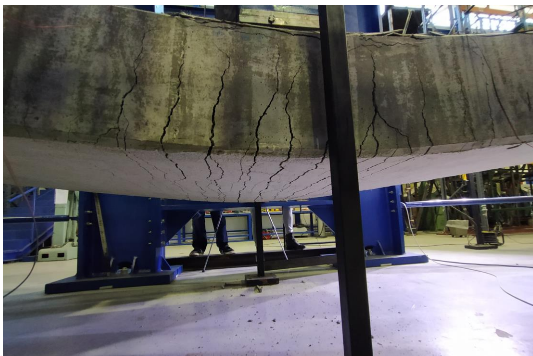
Σχήμα 4.10: Καμπτική ρηγμάτωση σκυροδέματος δοκιμίου H2.
