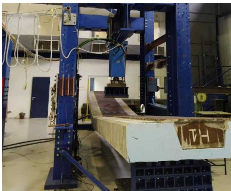
Σχήμα 2.25: Δοκίμιο Η1 μετά το πέρας της πειραματικής δοκιμής και την αφαίρεση των μετρητικών οργάνων.
