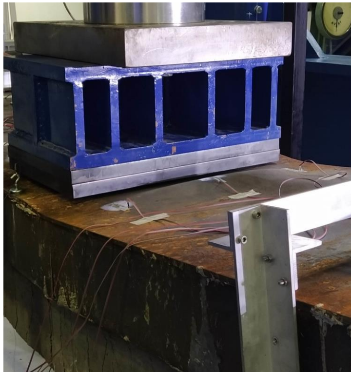
Σχήμα 4.32: Τοπικός λυγισμός του άνω πέλματος της σιδηροδοκού δοκιμίου Η6.
