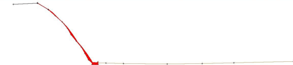
Σχήμα 1 : Διάγραμμα ύψους Αναπήδησης των βραχοτεμαχίων στο Πρανές 1 μετά την εφαρμογή των μέτρων ανάσχεσης καταπτώσεων
