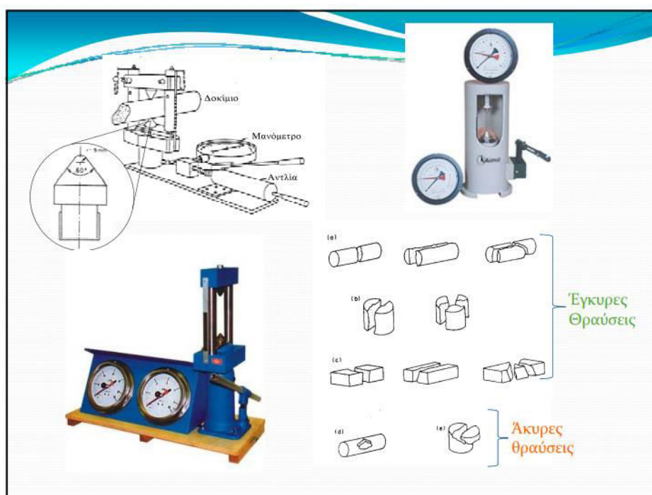
Εικόνα 3.7: Συσκευή δοκιμής σημειακής φόρτισης - Αποδεκτές και μη αποδεκτές περιπτώσεις θραύσεις επιφάνειας κατά τη δοκιμή (Λουπασάκης ,2015)
