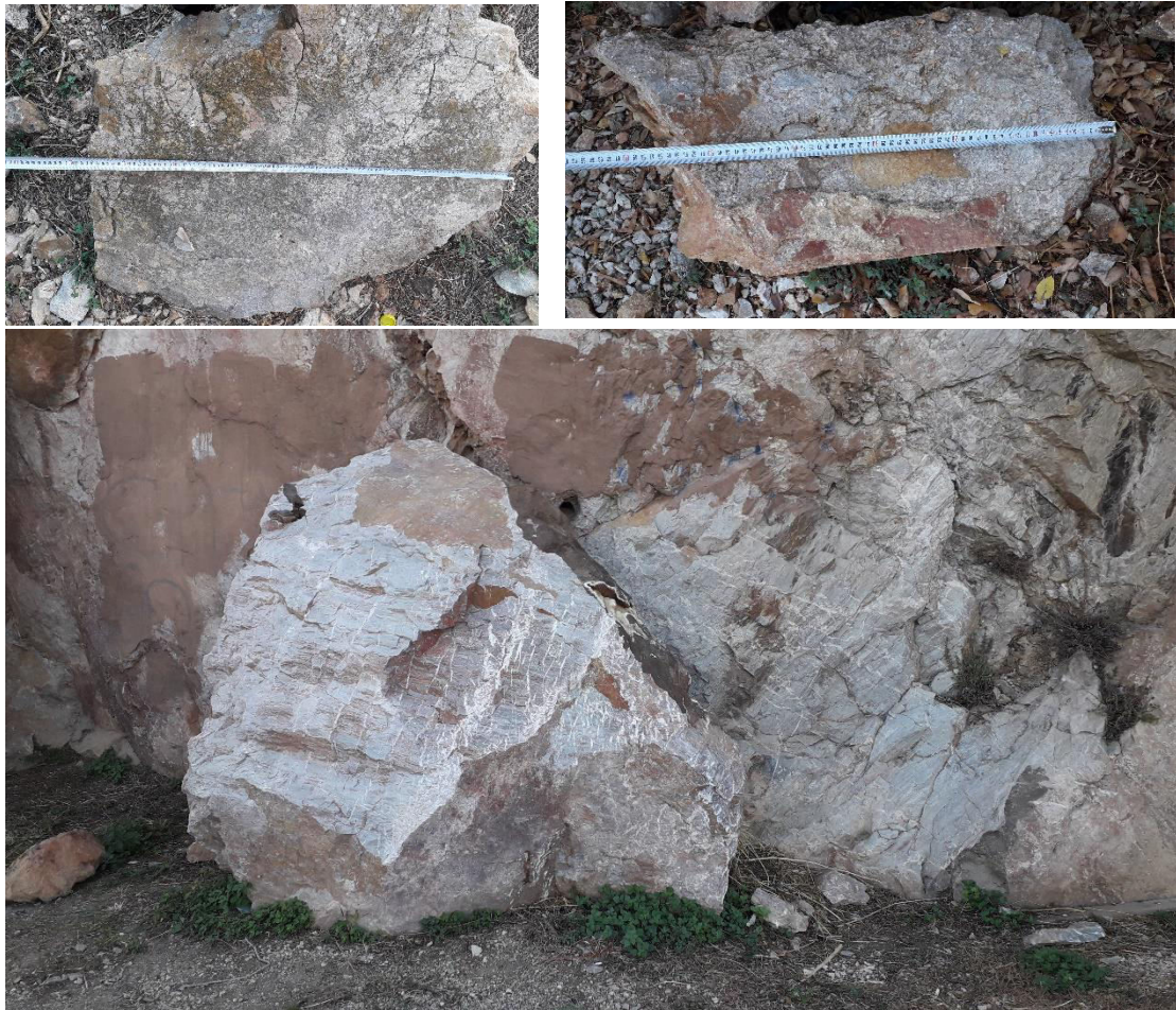
Εικόνα 5.6 και 5.7: Πάνω : Μέτρηση διαστάσεων κατακρημνισμένων βραχοτεμαχίων (προσωπικό αρχείο)
