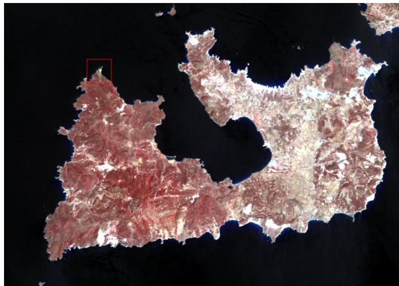
Εικ. III-5: Οι δύο δορυφορικές εικόνες είναι από τον δορυφόρο Landsat 5 TM, για την ημερομηνία λήψης 27/07/2001, με χρήση του προγράμματος ENVI, έκδοση 5.3. Η πρώτη εικόνα εμφανίζει έναν συνδυασμό καναλιών RGB 321 και η δεύτερη δείχνει την υγιή βλάστηση του νησιού έπειτα από έναν συνδυασμό καναλιών RGB 432.
