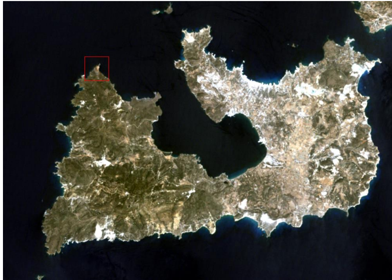
Εικ. III-5: Οι δύο δορυφορικές εικόνες είναι από τον δορυφόρο Landsat 5 TM, για την ημερομηνία λήψης 27/07/2001, με χρήση του προγράμματος ENVI, έκδοση 5.3. Η πρώτη εικόνα εμφανίζει έναν συνδυασμό καναλιών RGB 321 και η δεύτερη δείχνει την υγιή βλάστηση του νησιού έπειτα από έναν συνδυασμό καναλιών RGB 432.
