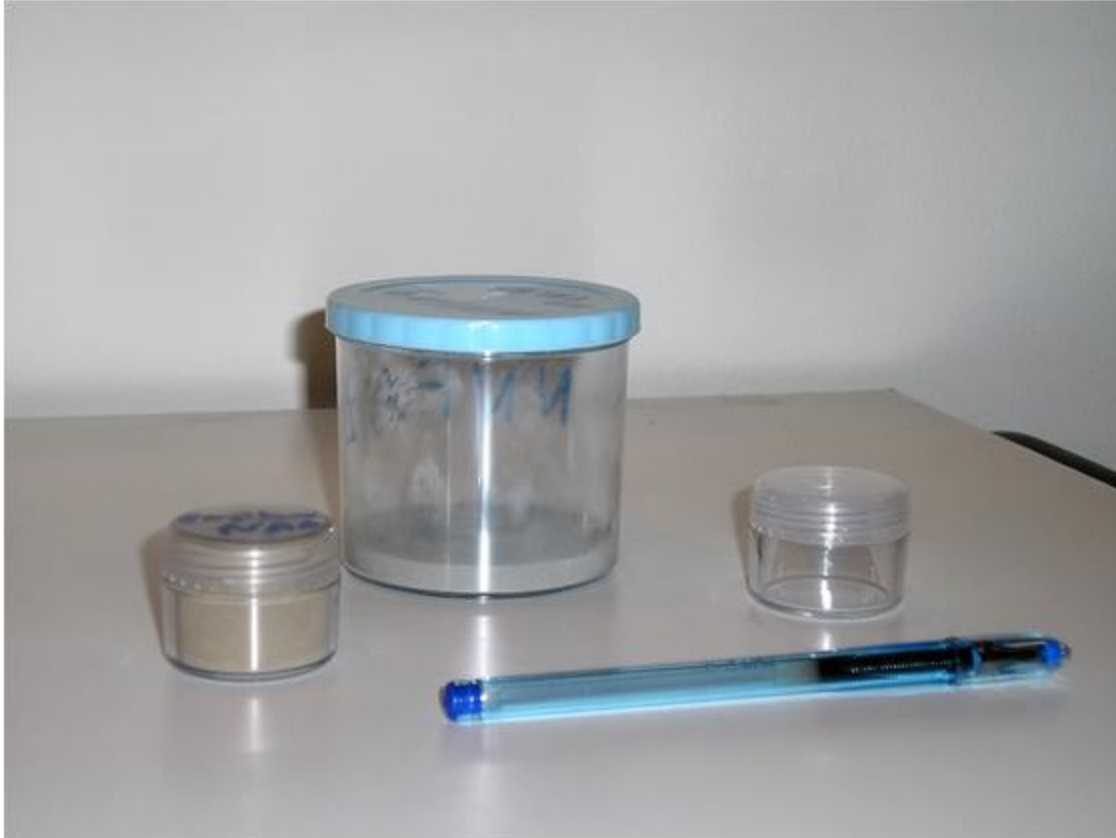
Σχήμα 2.4β: Φωτογραφία της κάψουλας ενεργοποίησης δείγματος όγκου 24.5ml και του δοχείου όγκου 282ml και διαμέτρου 72mm που το ενεργοποιημένο δείγμα τοποθετείται για την γ-φασματοσκοπική ανάλυση μετά την ενεργοποίηση για 20 ημέρες.
