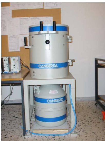
Εικόνα 3.4: (α) Ο ανιχνευτής XtRa με την θωράκισή του και το δοχείο αζώτου και (β) Ηλεκτρονικά υποστήριξης της ανιχνευτικής διάταξης XtRa.
