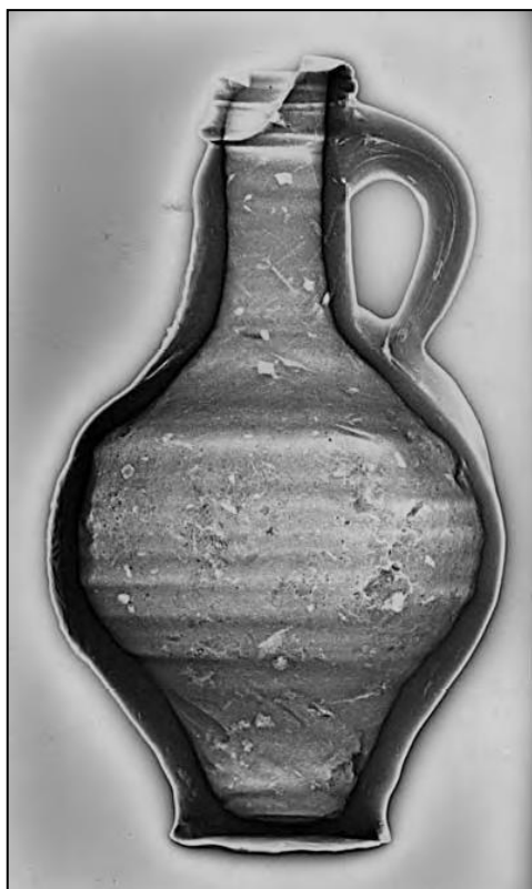
ΕΙΚΟΝΑ 5.4: Ραδιογραφία ενός βάζου Bellarmine του 17ου αιώνα. Ο λοξός προσανατολισμός των ατελειών είναι χαρακτηριστικό της χρήσης αγγειοπλαστικού τροχού (βλ. Lang, 2005).
