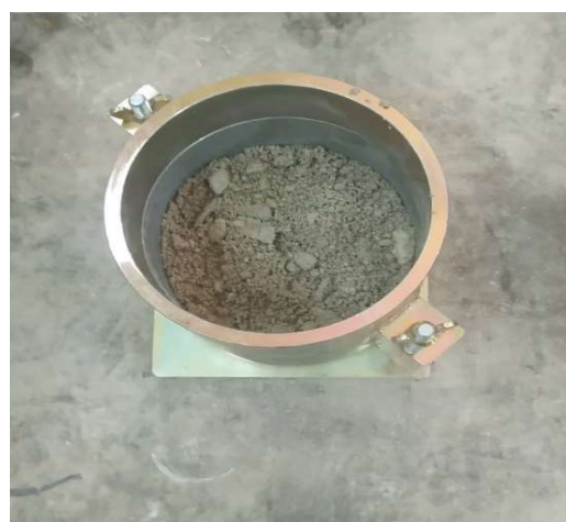
Εικόνα 6.11 Α. Ζύγιση υλικού Β. Τοποθέτηση στη μήτρα
