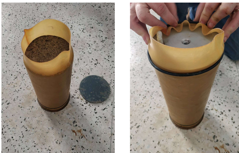
Εικόνα 6.17 Α. Δοκίμιο πριν την τοποθέτηση πορώδη δίσκου. Β. Δοκίμιο με τοποθέτηση ειδικού μεταλλικού καπακιού.
