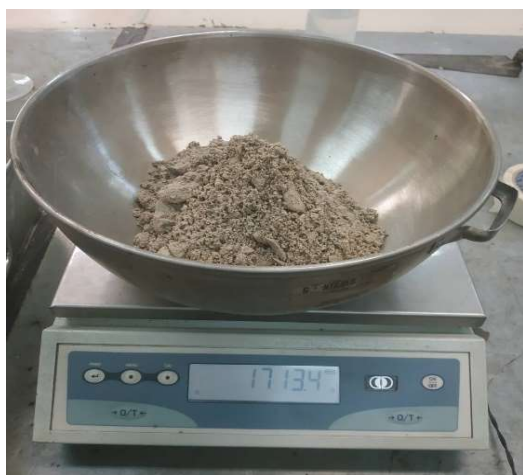
Εικόνα 6.11 Α. Ζύγιση υλικού Β. Τοποθέτηση στη μήτρα
