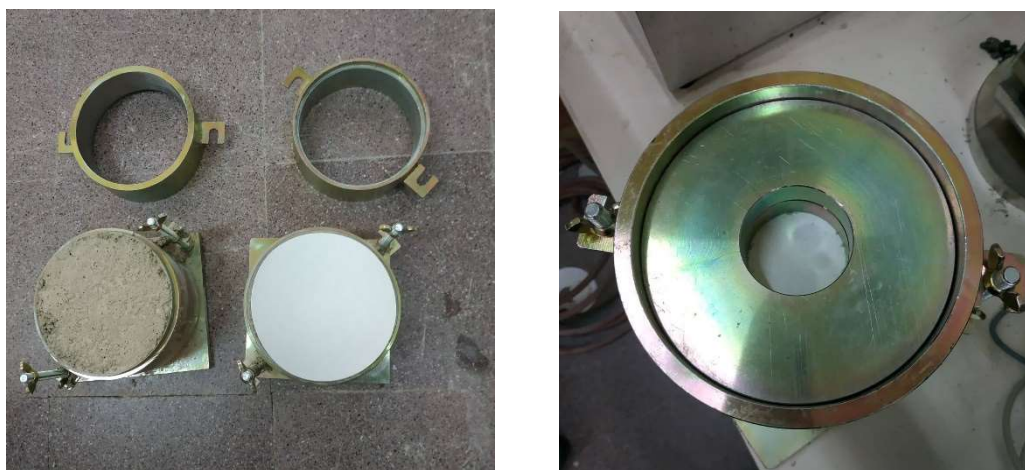
Εικόνα 6.14 Α. Τοποθέτηση διηθητικού χαρτιού πάνω στο υλικό. Β. Τοποθέτηση κυλινδρικού δίσκου.
