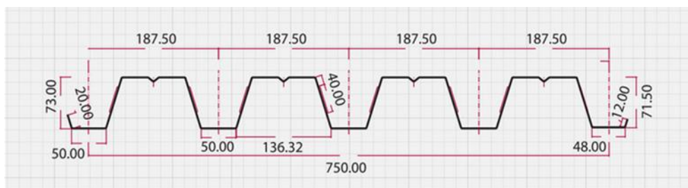
Σχήμα 3.5: Γεωμετρικά χαρακτηριστικά SYMDECK 73.
