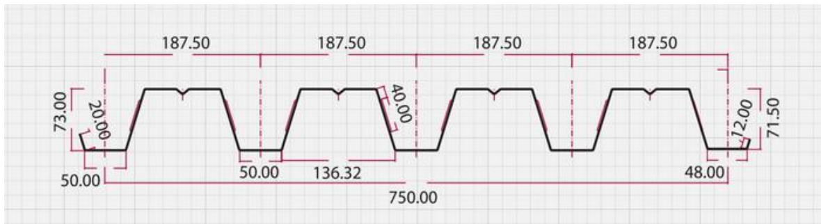
Σχήμα 1.2: Απεικόνιση γεωμετρικών χαρακτηριστικών χαλυβδόφυλλου SYMDECK 73.
