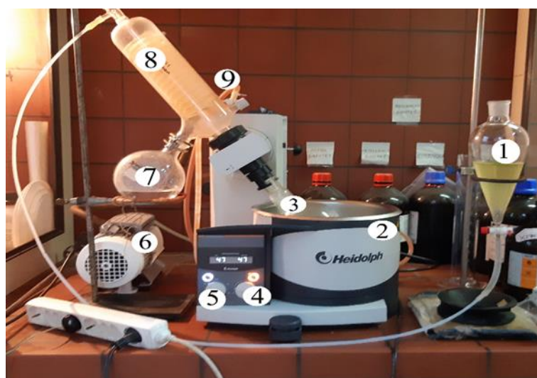
Εικόνα 5.9: Σύστημα συμπύκνωσης γλυκού ορού
