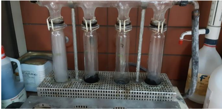
Εικόνα 5.3: Συσκευή καύσης Kjeldhal
