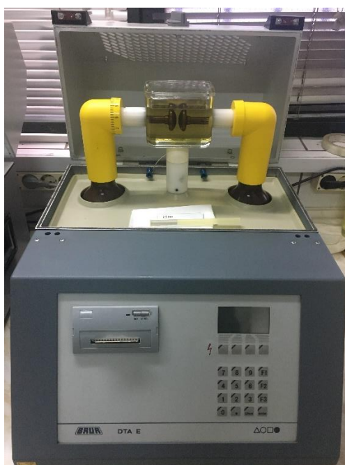
Σχήμα 4.11: Συσκευή μέτρησης διηλεκτρικής αντοχής DTA E - 100 (Πηγή: Αρχείο ΣΕΜ-Α)
