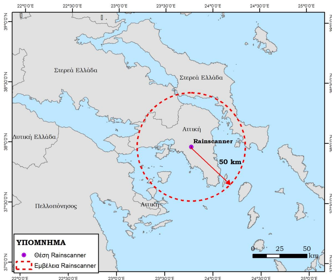
Σχήμα 2-4: Θέση και εμβέλεια Rainscanner του ΕΜΠ
