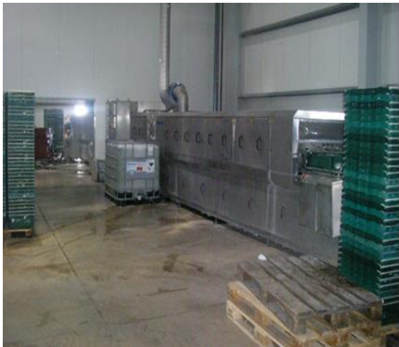
Εικόνα 14 Διάταξη πλυντηρίου τελάρων
