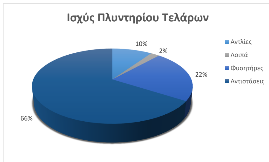
Εικόνα 16 Επιμερισμός Ισχύος πλυντηρίου
