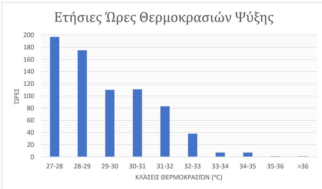
Εικόνα 27 Ετήσιες ώρες θερμοκρασιών ψύξης
