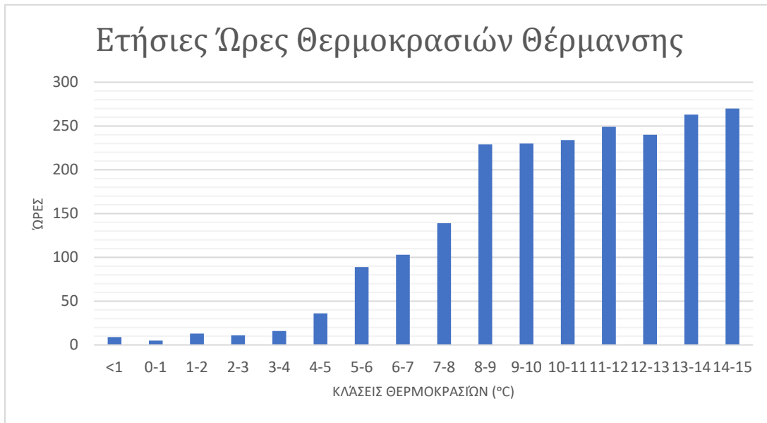
Εικόνα 26 Ετήσιες ώρες θερμοκρασιών θέρμανσης
