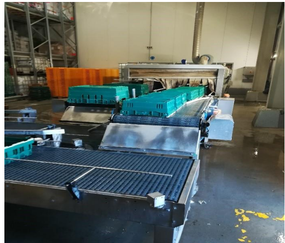
Εικόνα 15 Διάταξη πλυντηρίου τελάρων
