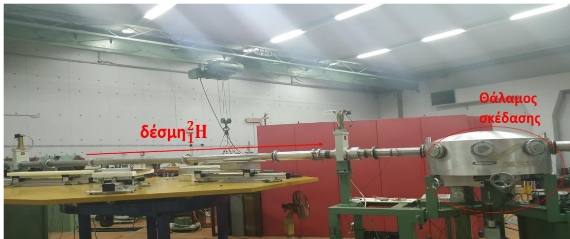
Εικόνα 2.2: Πειραματική γραμμή και εξωτερικό θαλάμου σκέδασης
