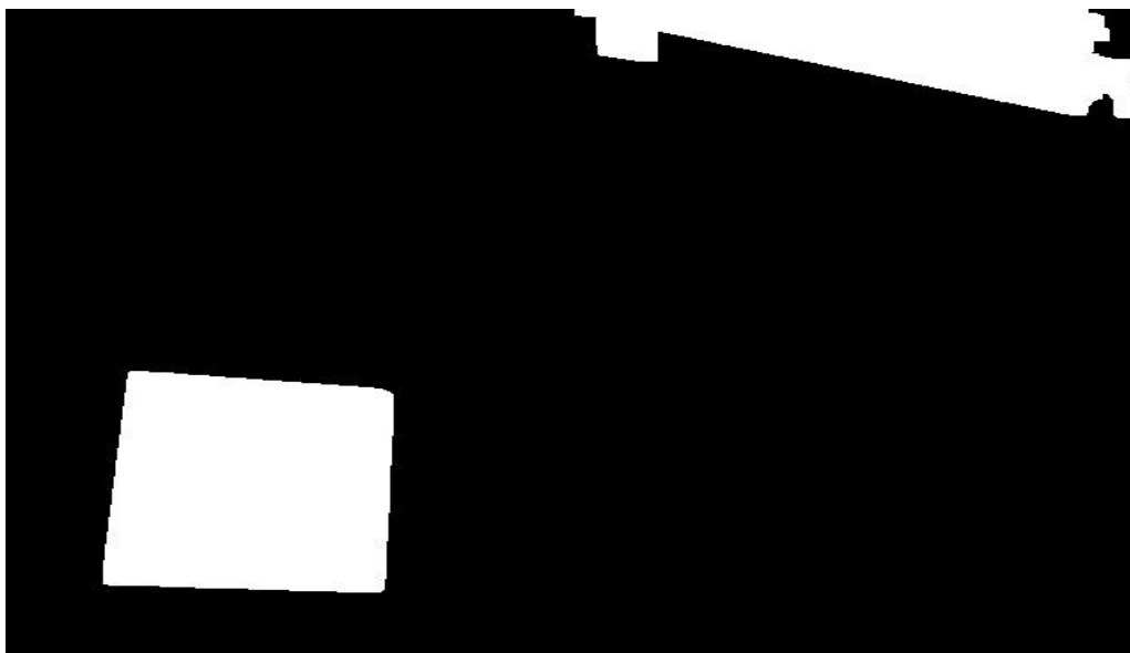
Σχήμα 3.9 Δυαδική Εικόνα με χρήση του Τελεστή Threshold
