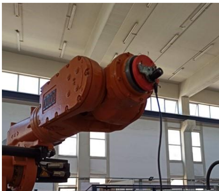
Σχήμα 3.4 Η Webcam PlayStation Eye προσαρτημένη στο Τελικό Στοιχείο Δράσης του Ρομποτικού Βραχίονα KUKA
