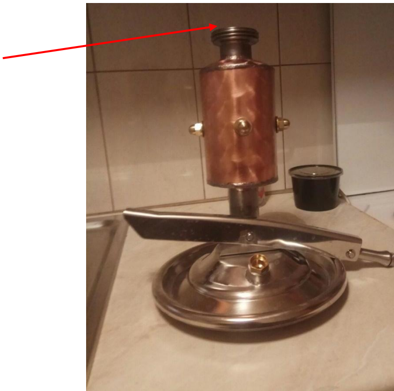
Εικ. 4.29 Ταχυσύνδεσμος INOX με ελαστικό παρέμβυσμα DN40
