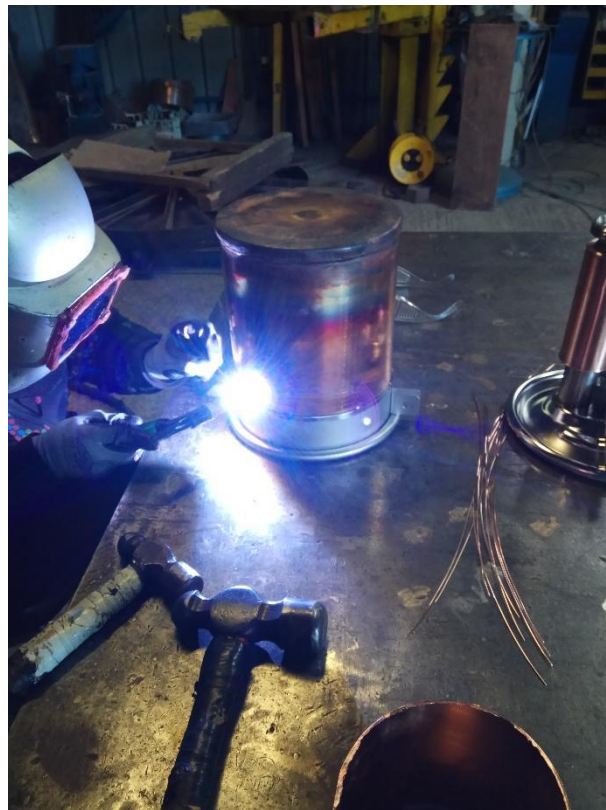
Εικ. 4.12 Συγκόλληση κυλινδρικού κομματιού INOX
