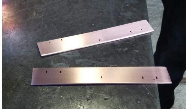
Εικ 4.13 Ορθογώνια κομμάτια χαλκού που πρόκειται να χρησιμοποιηθούν ως λαβές
