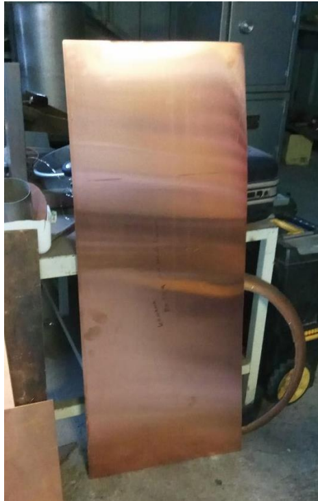
Εικ. 4.5 Φύλλο χαλκού για τη κατασκευή της θυρίδας βρασμού
