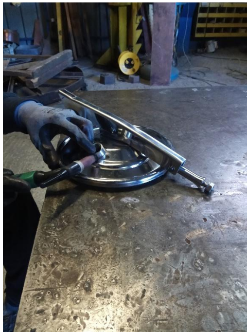
Εικ 4.20 Συγκόλληση δακτυλιδιού INOX
