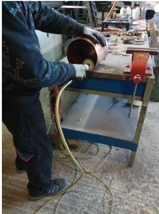
Εικ 4.10 Εσωτερικό γυάλισμα θυρίδας βρασμού
