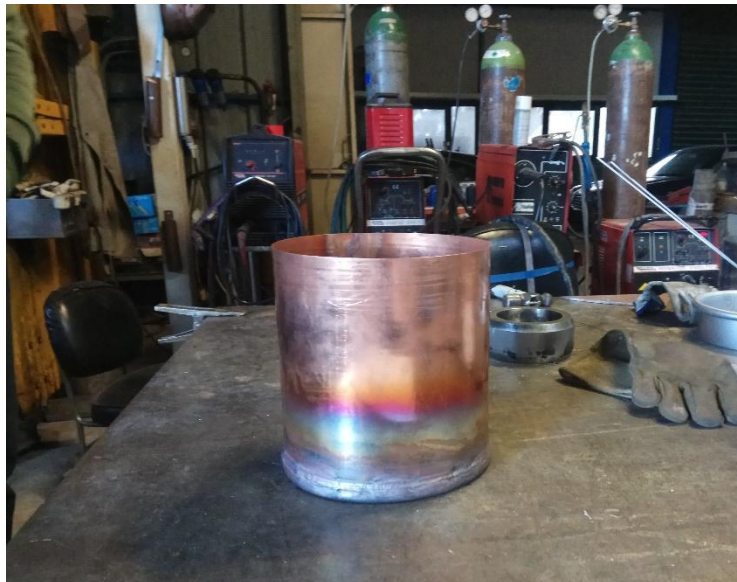
Εικ. 4.9 Θυρίδα βρασμού μετά το πρεσάρισμα και την συγκόλληση του πυθμένα. Οι διαφορετικοί χρωματισμοί του μετάλλου οφείλονται στις υψηλές θερμοκρασίες που αναπτύχθηκαν κατά την συγκόλληση.
