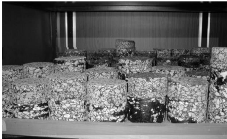
Εικόνα 2.16. Πυρήνες ασφαλτομίγματος στο εργαστήριο
