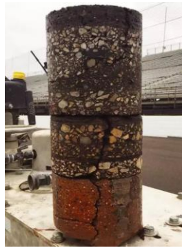
Εικόνα 2.7. Πυρηνοληψία υφιστάμενου οδοστρώματος
