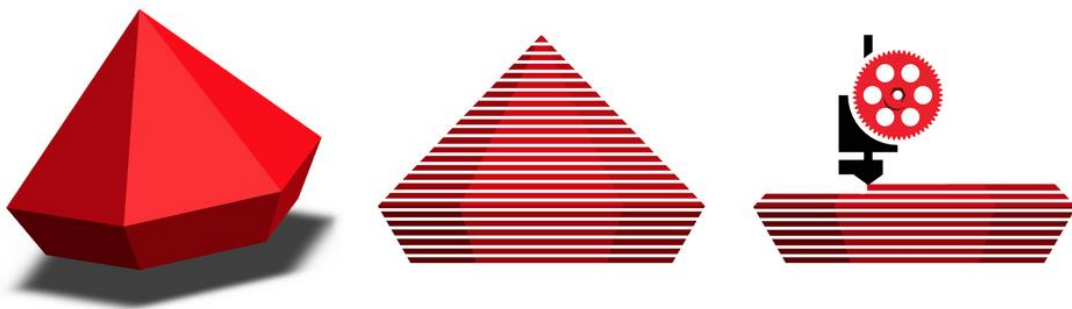
Εικόνα 10: Διαίρεση (slicing) του τεμαχίου σε layers
