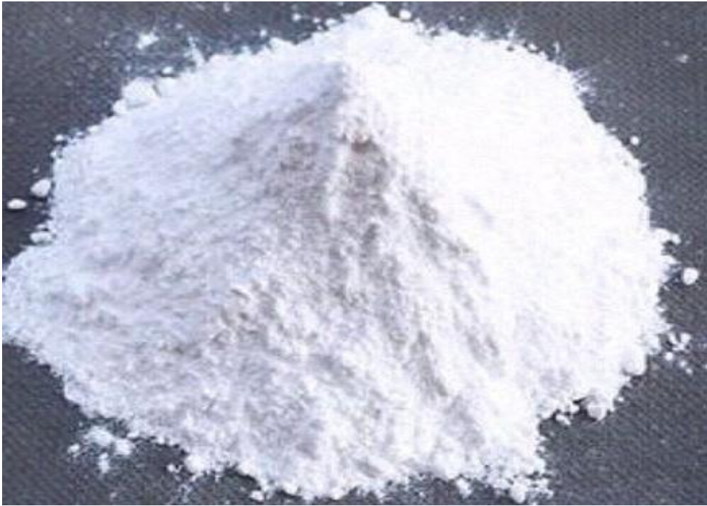
Εικόνα 18: Πολυαμίδιο 2200 σε μορφή πούδρας για εκτύπωση
