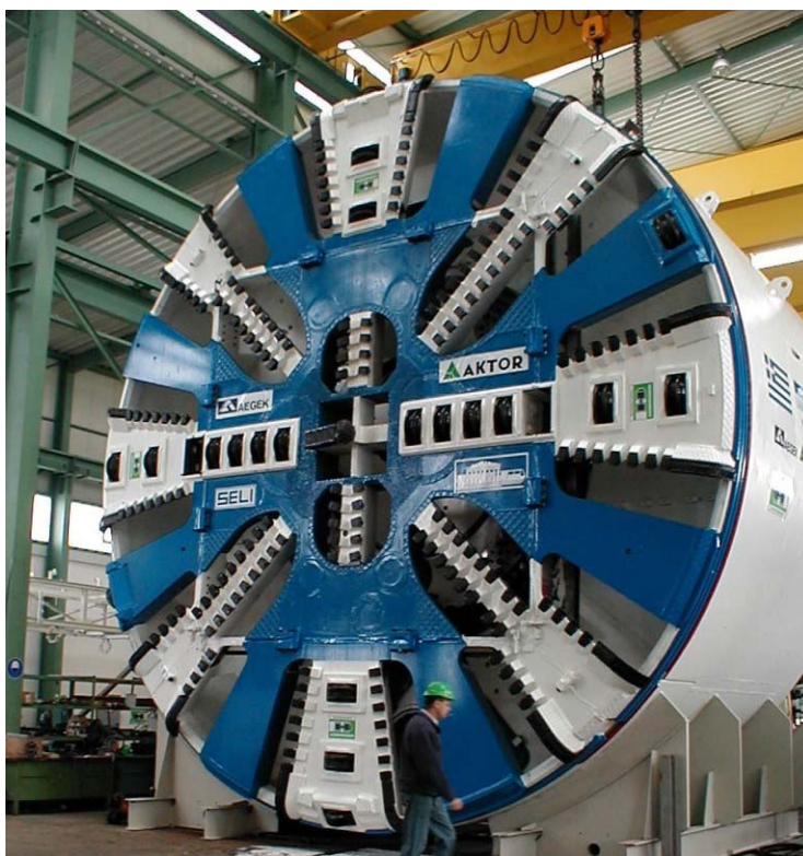
Εικ. 2-5: Ασπίδα Εξισορρόπησης Πίεσης Εδάφους (EPB) που χρησιμοποιήθηκε για την κατασκευή της Γραμμής 3 του ΜΕΤΡΟ ΑΘΗΝΩΝ, στο τμήμα σταθμός Χαλάνδρι – Φρέαρ Ξάνθου
