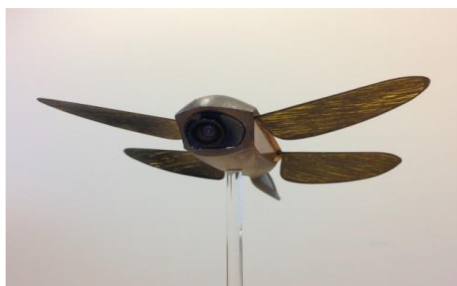
Εικόνα 18: Drone παλλόμενων πτερυγίων
