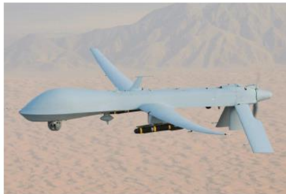
Εικόνα 11: Το MQ-1 Predator της General Atomics, εξοπλισμένο με πυραύλους
