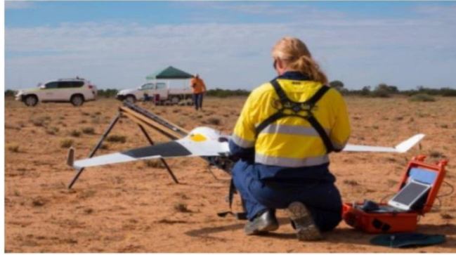
Εικόνα 31: Απογείωση UAV σταθερού εκπτετάσματος
