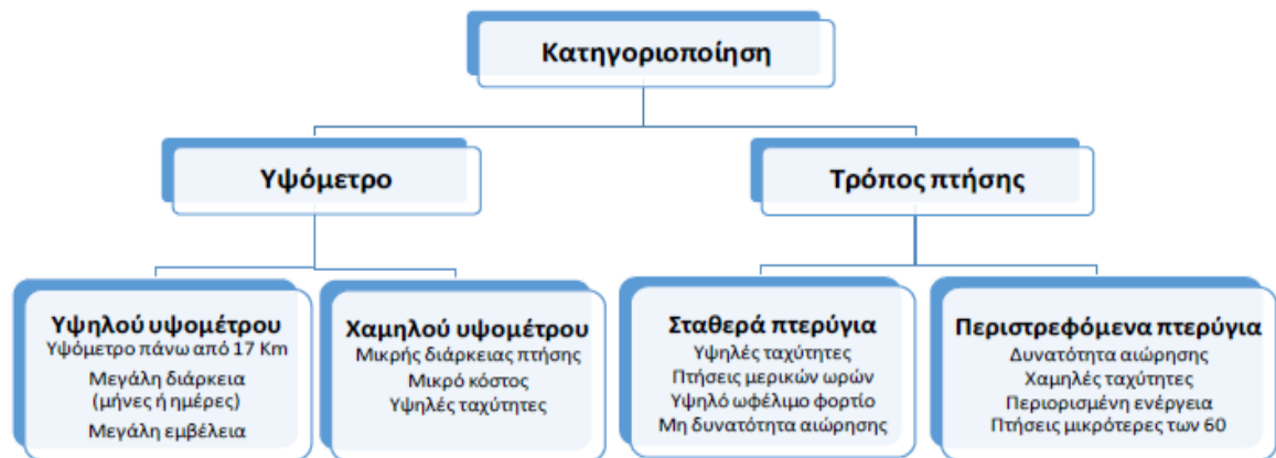
Εικόνα 15: Κατηγοριοποίηση των οχημάτων UAV με βάση το υψόμετρο ή τον τρόπο πτήσης
