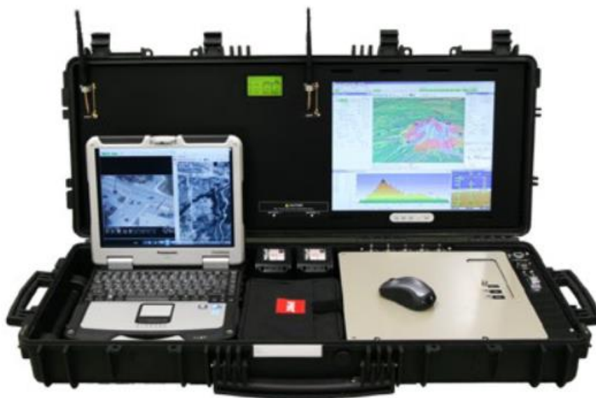
Εικόνα 64: Σταθμός ελέγχου εδάφους (GCS)
