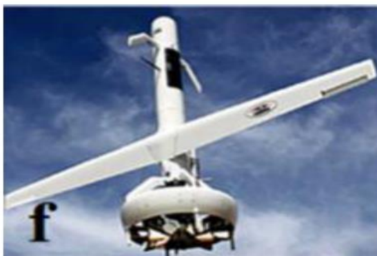
Εικόνα 19: Ducted fan drone
