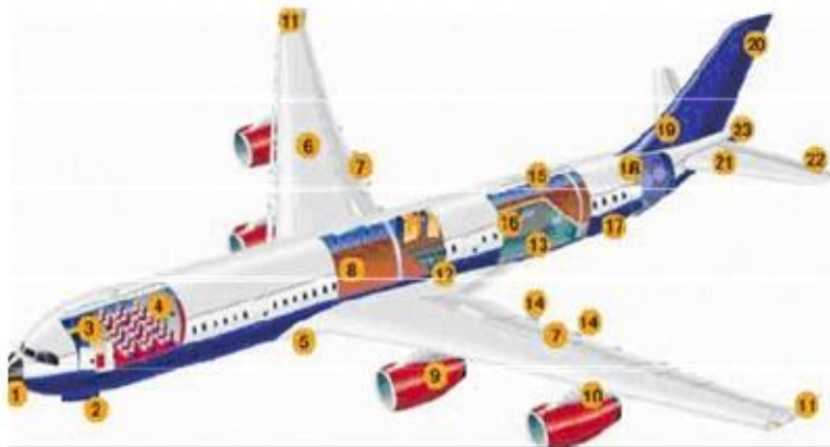
Σχήμα 9: Μέρη της ατράκτου και των πτερυγίων ενός πολιτικού όπου υπάρχουν δομικά στοιχεία από σύνθετα υλικά (Hexcel Composites).
