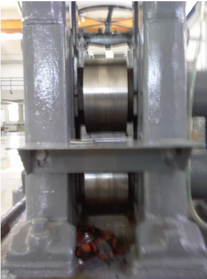
Εικόνα 8 : Έλαστρο Εργαστηρίου Τομέα Τεχνολογίας Κατεργασιών των Κατασκευών
