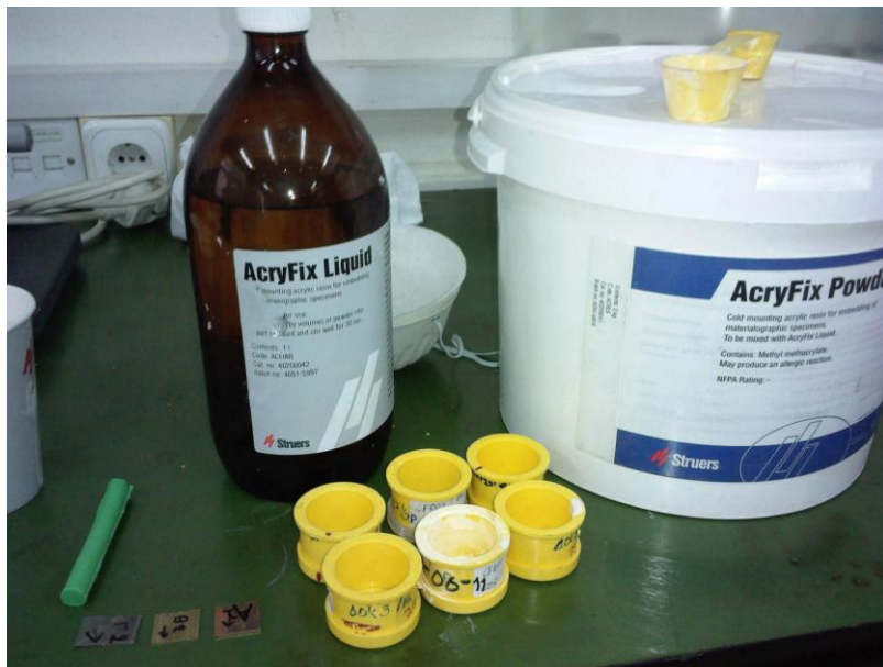
Εικόνα 9: Φαίνονται ο διαλύτης, η ρητίνη και τα κουτιά εγκιβωτισμού καθώς επίσης και τρία από τα δοκίμια μας.
