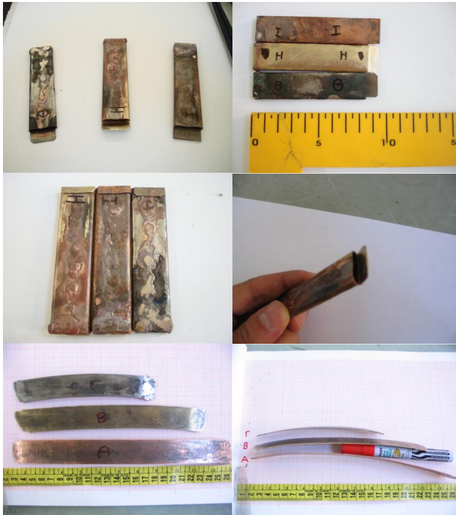
Εικόνα 6: Απεικόνιση των δοκιμών πριν και μετά την διεργασία της έλασης
