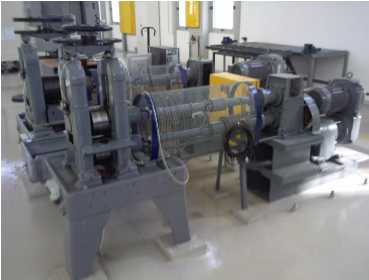
Εικόνα 7 : Έλαστρο Εργαστηρίου Τομέα Τεχνολογίας Κατεργασιών των Κατασκευών
