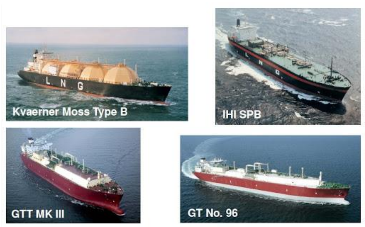
Εικόνα 1-16. Διάφοροι τύποι δεξαμενόπλοιων μεταφοράς LNG. Πάνω αριστερά πλοίο σφαιρικού σχεδιασμού, πάνω δεξιά πλοίο δομικά πρισματικού σχεδιασμού και κάτω δεξαμενόπλοια σχεδιασμού μεμβράνης τύπου MKII (αριστερά) και No. 96 (δεξιά). Πηγή: Liquefied Gas Carrier, http://www.liquefiedgascarrier.com/
