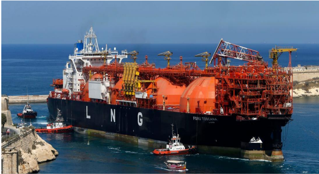
Εικόνα 2-23. FSRU Toscana. Πλωτός σταθμός αποθήκευσης και επαναεριοποίησης στην Τοσκάνη της Ιταλίας 137.000 m 3 . Πηγή: Quartz 2014, https://qz.com/
