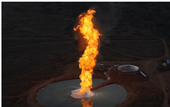
Εικόνα 3-5. Μεγαλύτερη δοκιμή φαινομένου pool fire (2009) υγροποιημένου φυσικού αερίου διαμέτρου 56 m και ύψους 146 m. Πηγή: National Technology and Engineering Solutions of Sandia
