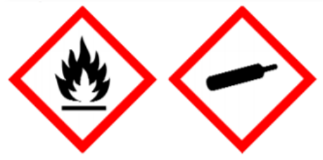
Εικόνα 1-23. Εικονογράμματα κινδύνου CLP για LNG. Αριστερά σύμβολο που υποδεικνύει εύφλεκτο μίγμα και δεξιά σύμβολο αερίου υπό πίεση.
