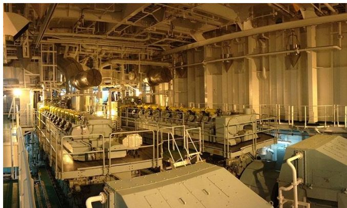
Εικόνα 2-15. Μηχανοστάσιο στο Velikiy Novgorod με ηλεκτρικό ντίζελ, σύστημα πρόωσης διπλού καυσίμου που αποτελείται από κινητήρες 2 × MAN 8L51/ 60DF και 2 × MAN 9L51 / 60DF.
