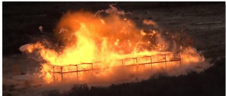
Εικόνα 3-6. Δοκιμή έκρηξης αέριου νέφους μεγέθους 975 m 3 .
