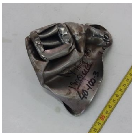
Εικόνα 27: Κατόψεις και πλάγιες όψεις του δοκίμιου 40-100-3 στο τέλος του πειράματος και της προσομοίωσης αντίστοιχα.
