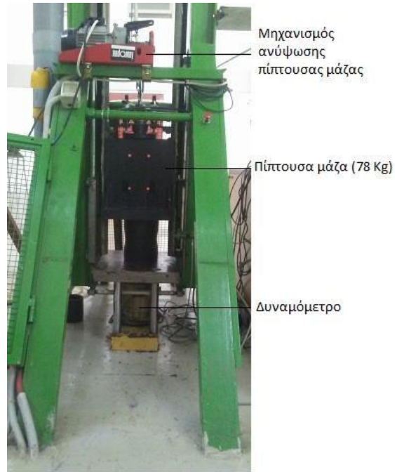
Εικόνα 6: Διάταξη σφύρας δυναμικών δοκιμών.
