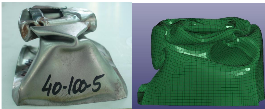
Εικόνα 18: Κατόψεις, ανόψεις και πλάγιες όψεις του δοκιμίου 40-100-5 με το πέρας του πειράματος και της προσομοίωσης αντίστοιχα.
