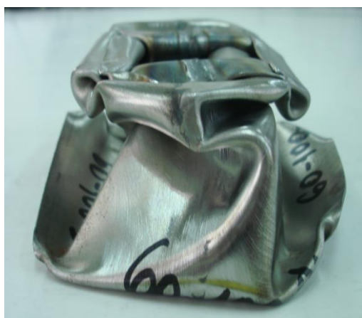
Εικόνα 21 : Κατόψεις, ανόψεις και πλάγιες όψεις του δοκιμίου 60-100-1 του πειράματος και της προσομοίωσης μετά το πέρας της δοκιμής θλίψης.
