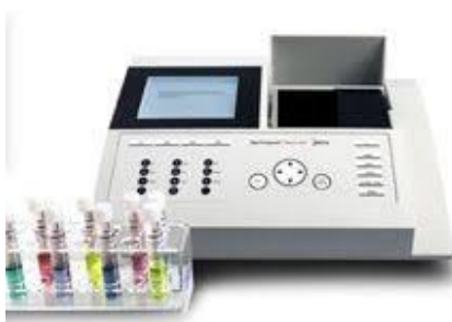
Εικόνα 4.4: Φωτόμετρο Spectroquant Pharo 300 Merck μαζί με τις κατάλληλες κυψελίδες που φαίνονται στα αριστερά της φωτογραφίας
