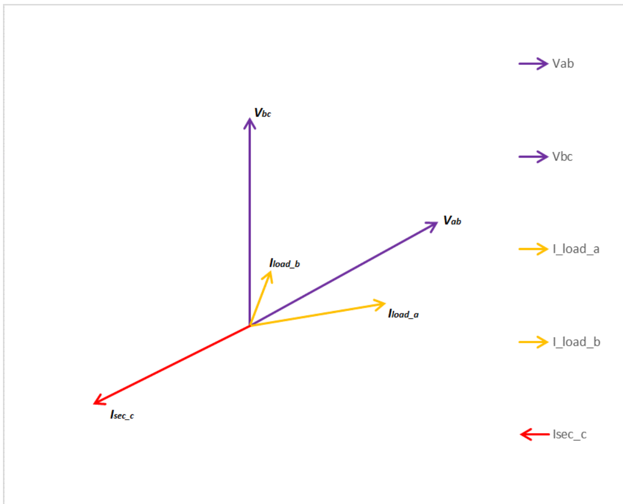
Εικόνα 3.8: Φόρτιση στο δευτερεύον με συντελεστή ισχύος φορτίου διάφορο του 1.
