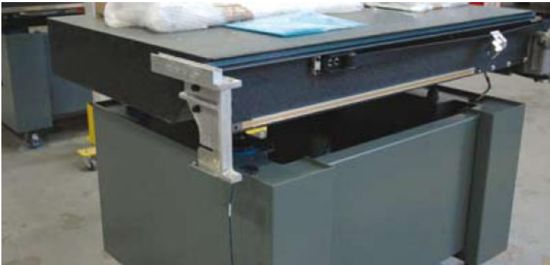
Εικ.4.10 Τράπεζα από γρανίτη, της εταιρείας DEA, τοποθετημένη πάνω στη βάση. (Measureur, 2009)
