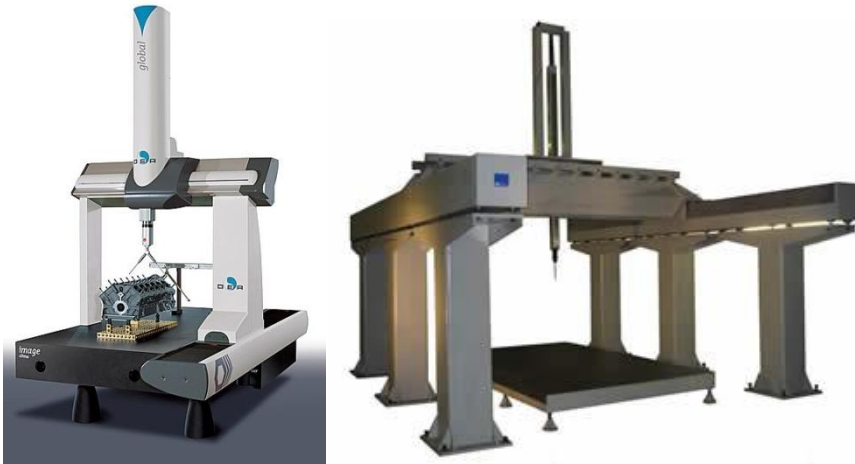
Εικ.4.11 CMM τύπου γέφυρας και ικρίωματος αντίστοιχα
