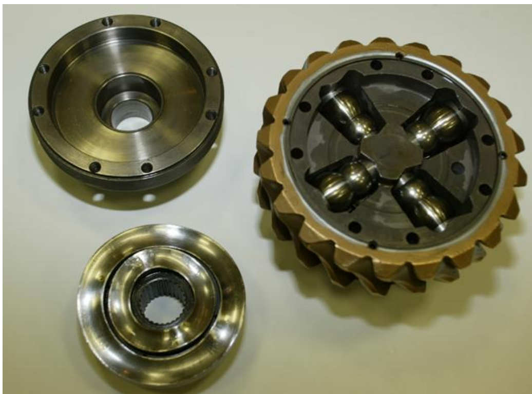
Εικ.4.4 Αφαίρεση Πλανήτη Διαφορικού (Πηγή: http://www.tsiriggakis.gr/Images/GD/GearlessDifferential028(640x470).jpg )
