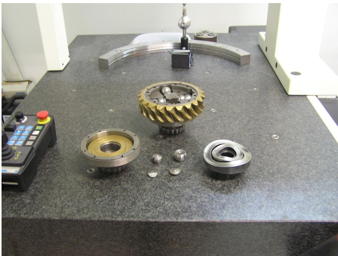
Εικ.4.7 Εξαρτήματα Διαφορικού τοποθετημένα στη Μηχανή Μέτρησης Συντεγμένων (CMM) (Πηγή: Εργαστήριο Ταχείας Κατασκευής Πρωτοτύπων & Εργαλείων - Αντίστροφου Σχεδιασμού)
