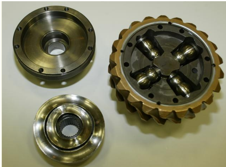
Εικ.2.22 Εξαρτήματα ένσφαιρου διαφορικού (Πηγή: http://www.tsiriggakis.gr/Images/GD/GearlessDifferential028(640x470).jpg )
