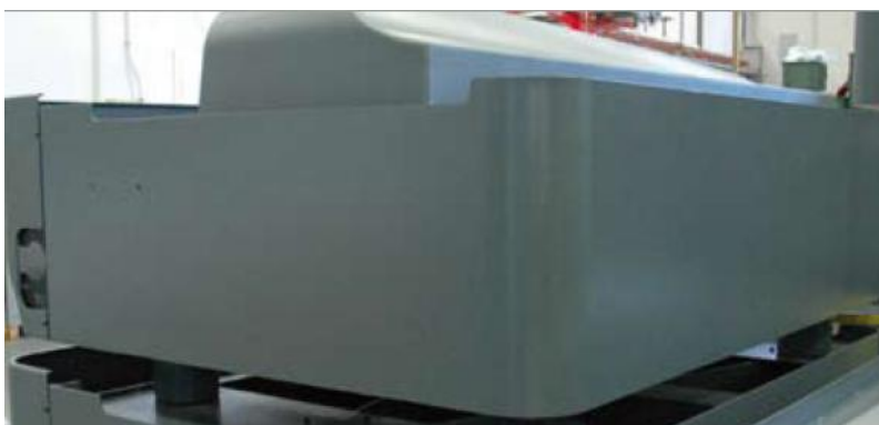
Εικ.4.9 Βάση από χάλυβα, που χρησιμοποιείται στη συναρμολόγηση της DEA CMM. (Measureur, 2009)
