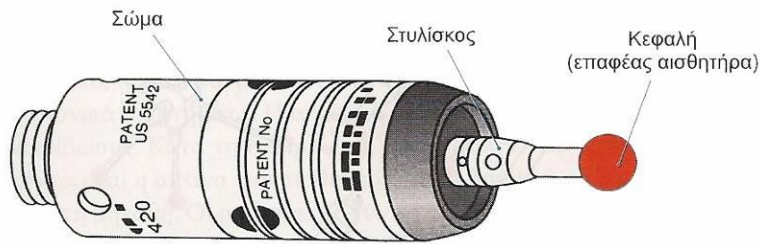
Εικ.4.13 Σχέδιο αισθητήρα επαφής στο οποίο αναγράφονται τα βασικά στοιχεία του. (Μανσούρ & Καραχάλιου, 2007)
