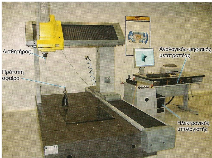
Εικ.4.8 Ολοκληρωμένο σύστημα μέτρησης με CMM. Διακρίνεται το κυρίως σώμα, αλλά και ο υπόλοιπος εξοπλισμός. (Μανσούρ & Καραχάλιου, 2007)
