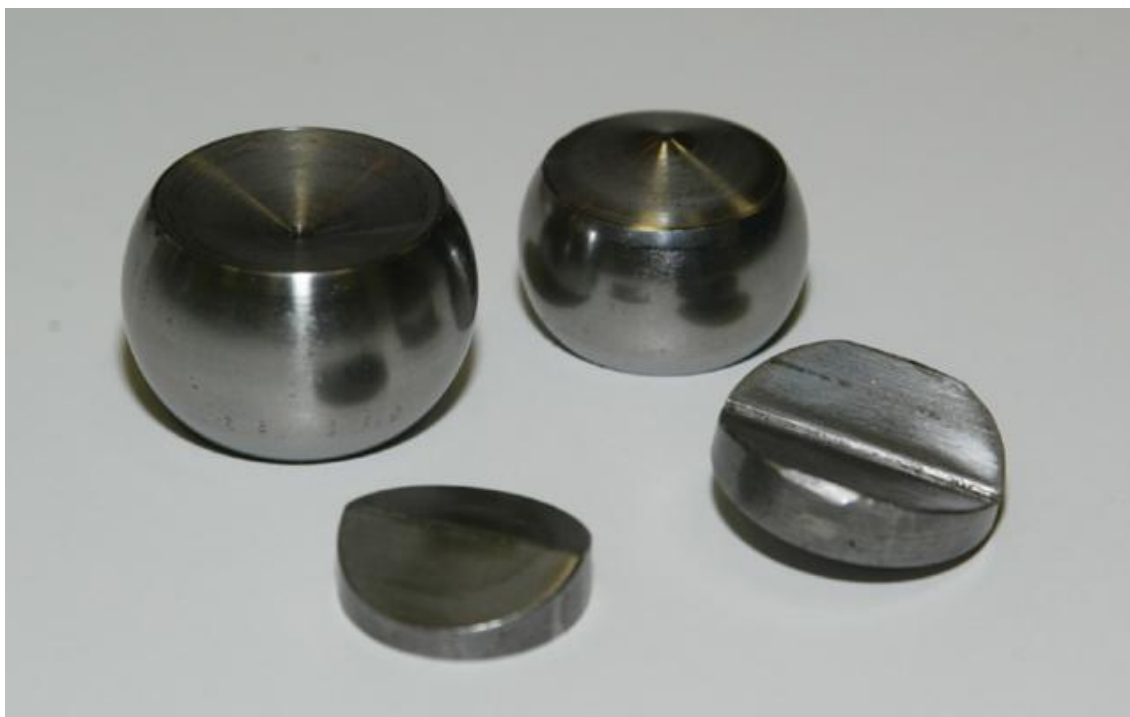
Εικ.4.6 Σετ Δορυφόρων Διαφορικού (Πηγή: http://www.tsiriggakis.gr/Images/GD/PairOfSatellites005(640x402).jpg )
