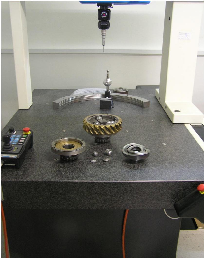
Εικ.4.14 Εξαρτήματα Διαφορικού τοποθετημένα στη Τράπεζα Μέτρησης της CMM
