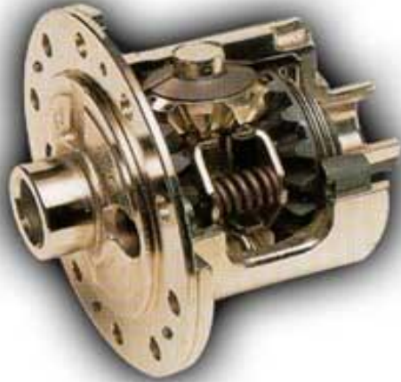
Εικ.2.12. Διαφορικό τύπου “μπλοκέ” σε τομή (Πηγή: http://www.syntheticoilnlubes.com/images/limited_slip_diff.jpg )
