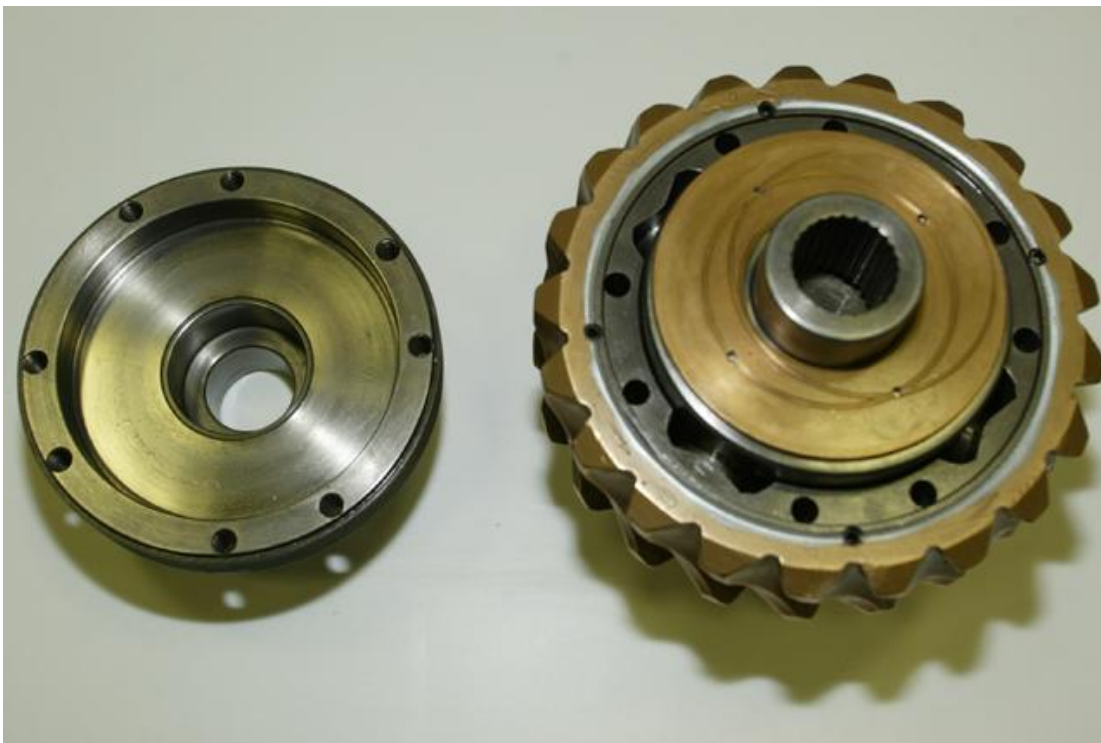
Εικ.4.3 Αφαίρεση Καπακιού Ασφαλείας Διαφορικού (Πηγή: http://www.tsiriggakis.gr/Images/GD/GearlessDifferential027(640x428).jpg )
