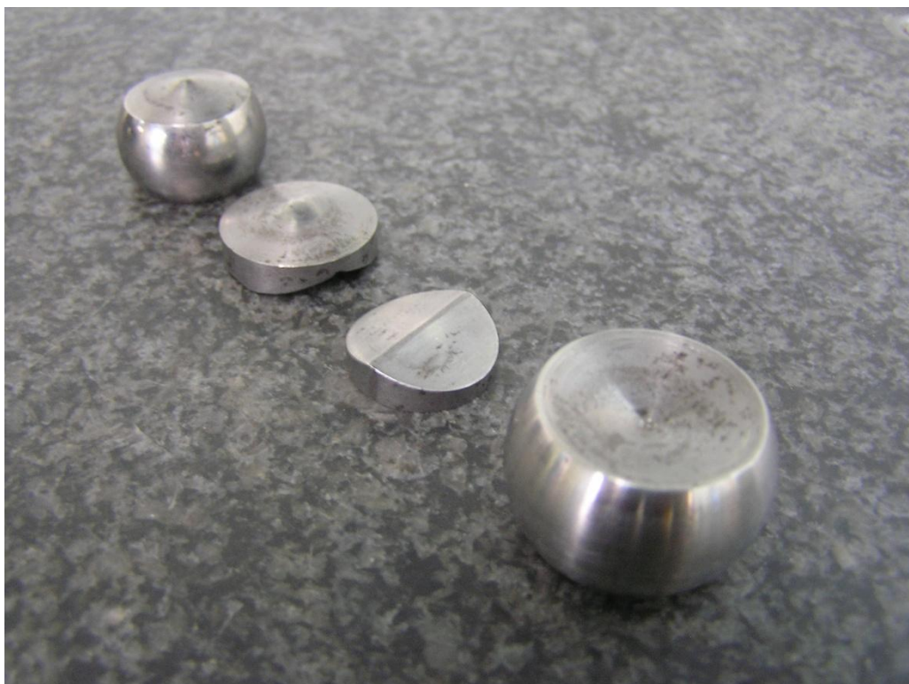
Εικ.4.15 Αποσυναμολόγηση πλανητών από τις εδράσεις τους και προετοιμασία προς μέτρηση
