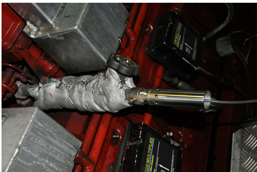
Σχήμα 5.5: Λήψη μετρήσεων πίεσης μέσω του indicator cock
